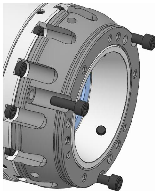
1. アダプターリングの止めネジを緩め、取り外します。
