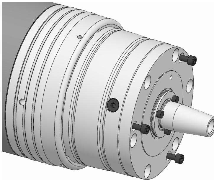
5. モジュラーシステム用アダプターの止めネジをねじ込み、規定の締付けトルクで締めます（「ネジの締め付けトルク」の章を参照）。
