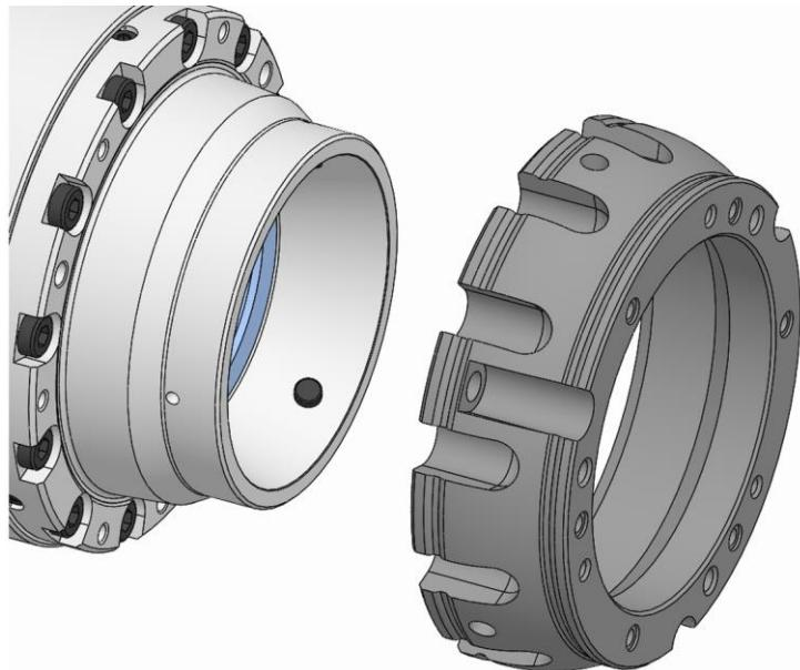
1. 基本クランプ装置にアダプターリングを置きます。
