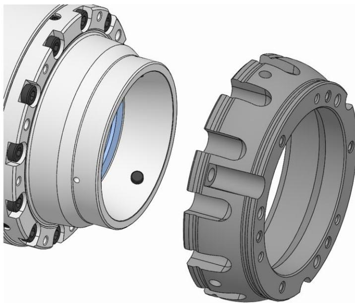
2. アダプターリングを基本クランプ装置から取り外します。
