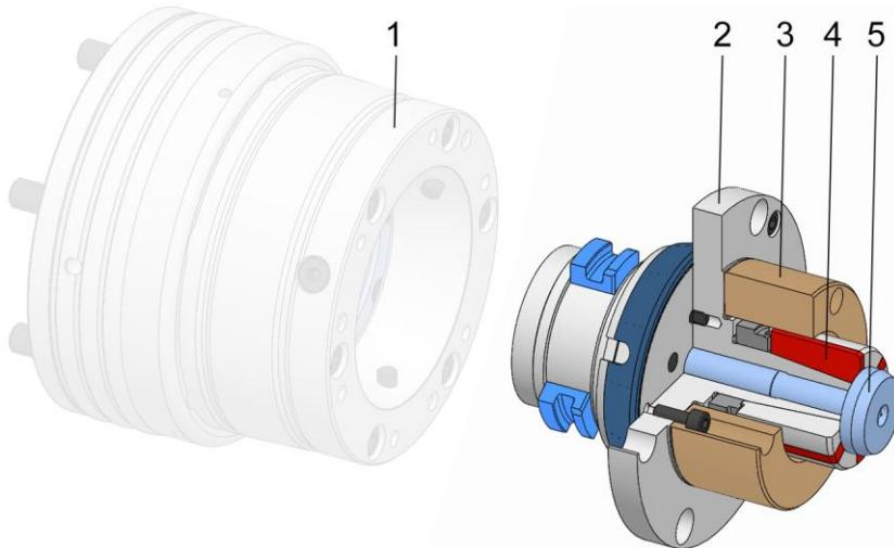
モジュラーシステム用アダプターは、外径クランプから内径クランプに換装するために使用します。
