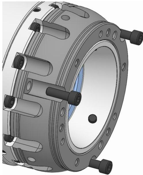
2. アダプターリングの止めネジをねじ込み、規定の締付けトルクで締めます（「ネジの締め付けトルク」の章を参照）。
