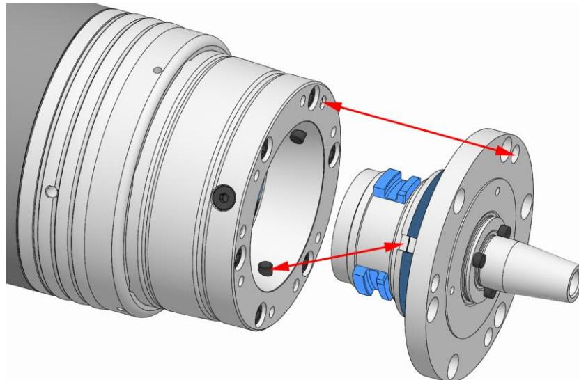
4. 基本クランプ装置の穴パターンがアダプターの形状に対応するように、アダプターを基本クランプ装置にはめ込みます。その際に、基本クランプ装置のクランプテーパーの回り止めキーとモジュラーシステム用アダプターの溝が重なるようにします。
