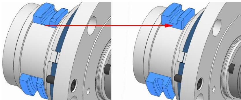
5. すべてのカップリングスライダの動きを確認します。ドローボルトをねじ込むと、すべてのカップリングスライダがそれぞれ外側に向けて動く必要があります。
