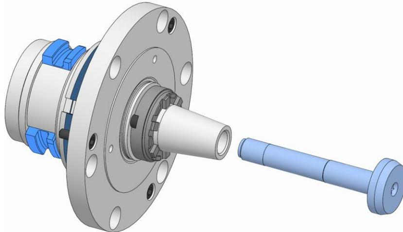
1. ドローボルトを緩め、取り外します。その際、イジェクターが抜け落ちないようにしてください。
