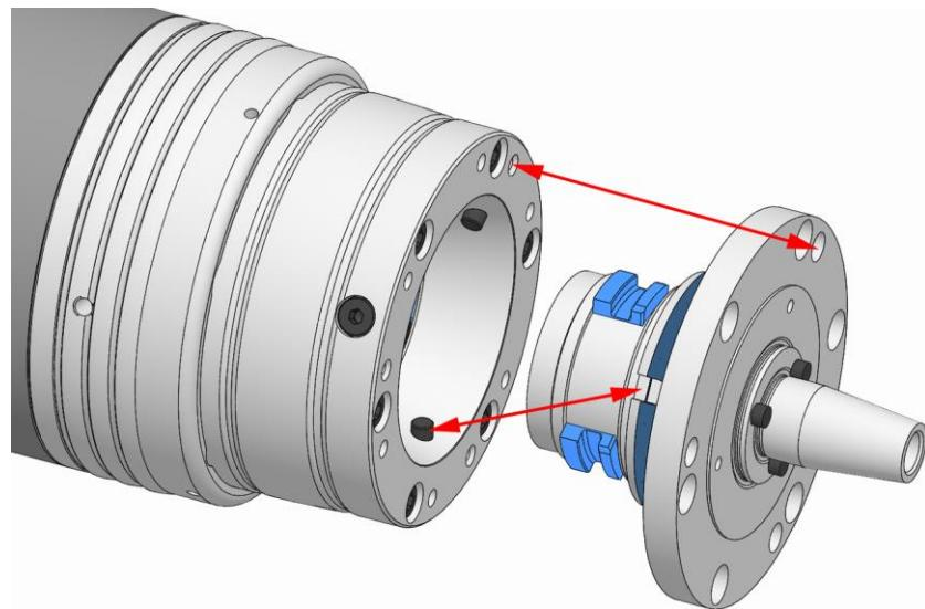
6. モジュラーシステム用アダプターを基本クランプ装置から取り外します。
