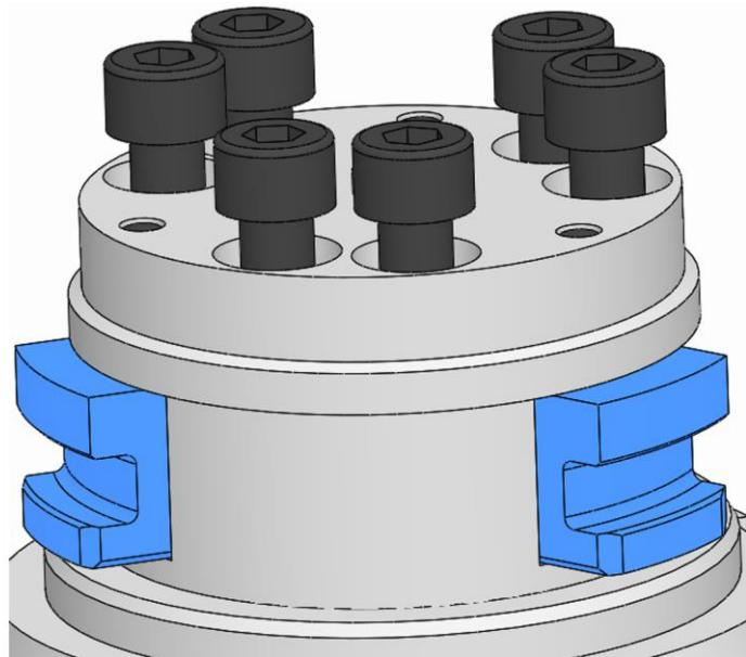
4. カップリングカバーの止めネジをねじ込み、規定の締付けトルクで締めます（「ネジの締め付けトルク」の章を参照）。
