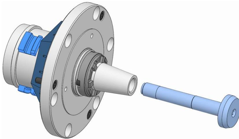
2. ドローボルトを緩め、取り外します。その際、イジェクターが抜け落ちないようにし、カップリングスライダの動きに気を付けてください。
