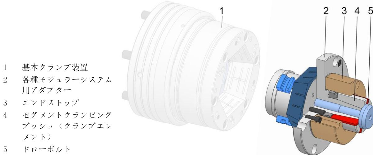
モジュラーシステム用アダプターは、外径クランプから内径クランプに換装するために使用します。
