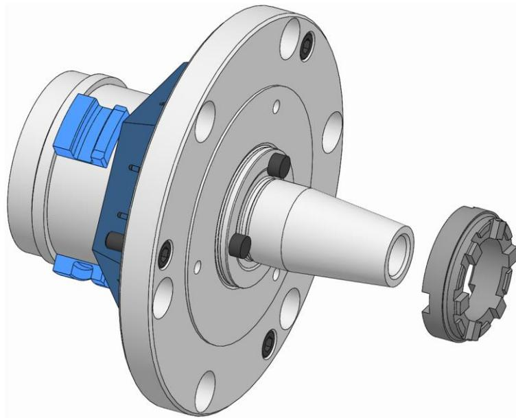
7. イジェクターの溝とイジェクターピンが一致するよう に、イジェクターを製品に置きます。
