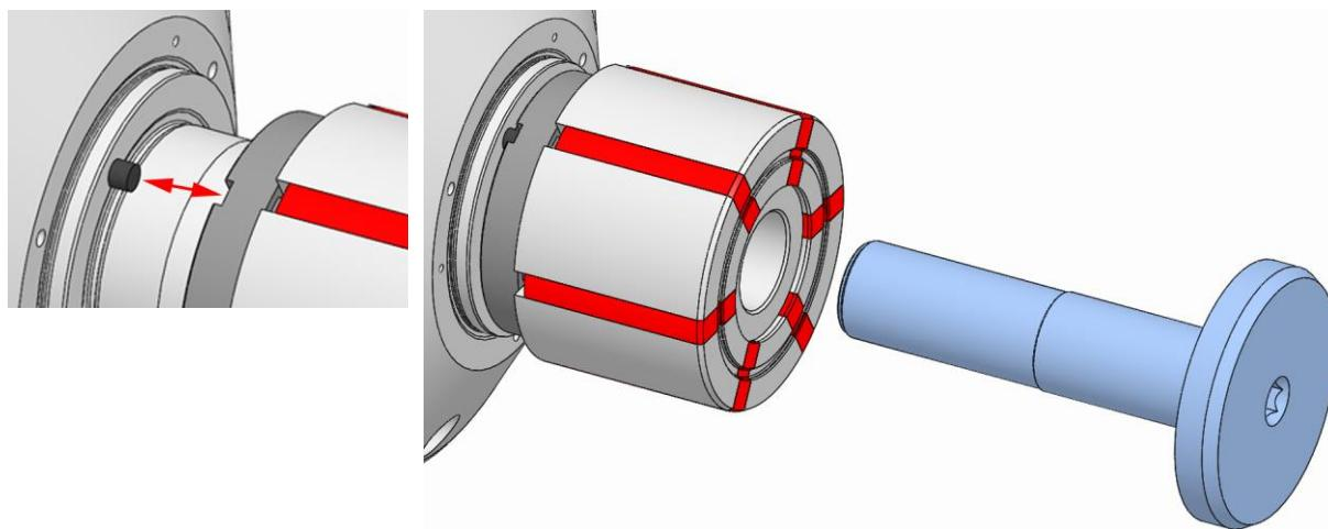
3. ドローボルトを緩め、取り外します。その際、イジェクターとセグメントクランピングブッシュが抜け落ちないようにしてください。
