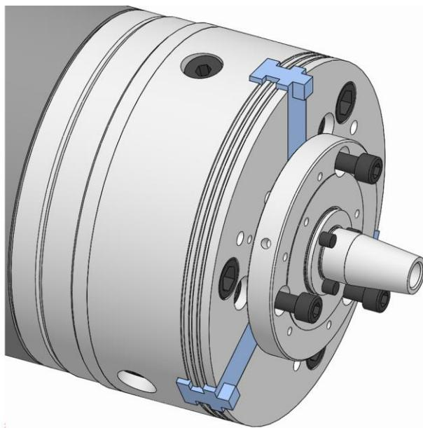
5. モジュラーシステム用アダプターの止めネジを緩め、取り外します。
