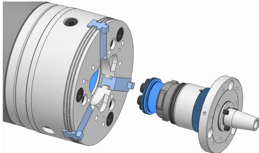
6. モジュラーシステム用アダプターを基本クランプ装置から取り外します。
