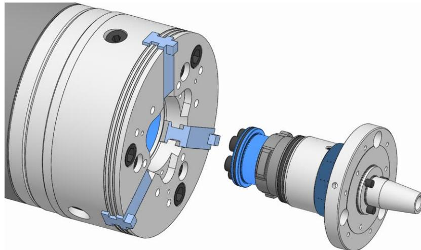
4. モジュラーシステム用アダプターのバヨネットの突起が基本クランプ装置の開口部に嵌るように、アダプターを基本クランプ装置にはめ込みます。その際、モジュラーシステム用アダプターの円筒ピンを基本クランプ装置の位置決め穴の方向に  $60^{\circ}$  回しておかなければなりません。
