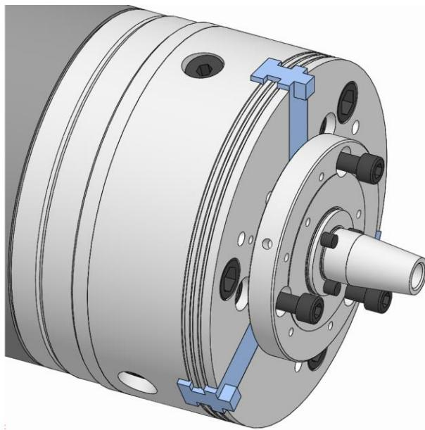
6. モジュラーシステム用アダプターの止めネジをねじ込み、規定の締付けトルクで締めます（「ネジの締め付けトルク」の章を参照）。
