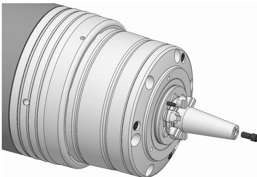
7. ロッキングスクリーを規定の締め付けトルクで締めます（「ネジの締め付けトルク」の章を参照）。
