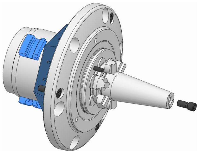
9. ロッキングスクリューを規定の締め付けトルクで締めます（「ネジの締め付けトルク」の章を参照）。
