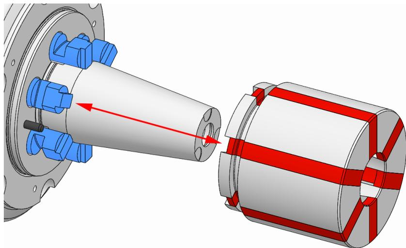
4. セグメントクランピングブッシュを製品に嵌め、抜け落ちないようにします。このとき、セグメントクランピングブッシュのスリットがカップリングの突起に咬み合っていなければなりません。
