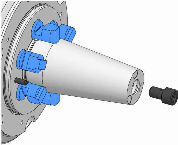
3. 交換ジグが製品に同梱されている場合は、それを使用してロックングスクリューを緩め、取り外します。
