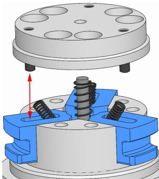
3. カップリングカバーのピンがカップリングリングの溝の位置に来るように、カップリングカバーを同心円状に水平位置に置きます。
