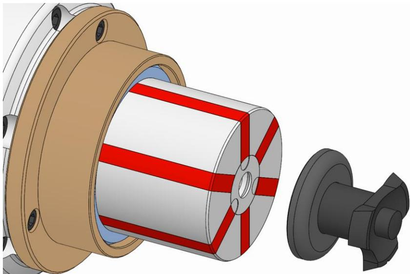
8. 場合により使用している交換ジグを緩め、取り外します。
