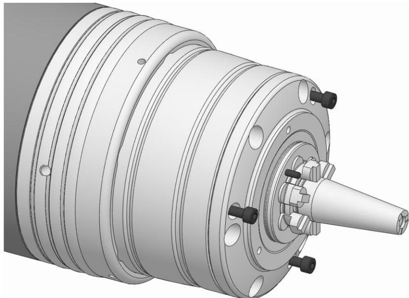
5. モジュラーシステム用アダプターの止めネジをねじ込み、規定の締付けトルクで締めます（「ネジの締め付けトルク」の章を参照）。
