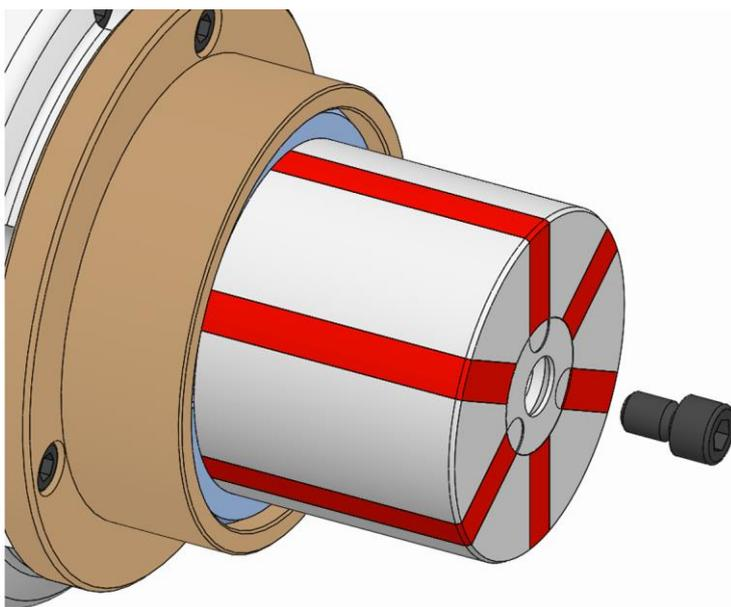
9. ロッキングスクリューを規定の締め付けトルクで締めます（「ネジの締め付けトルク」の章を参照）。
