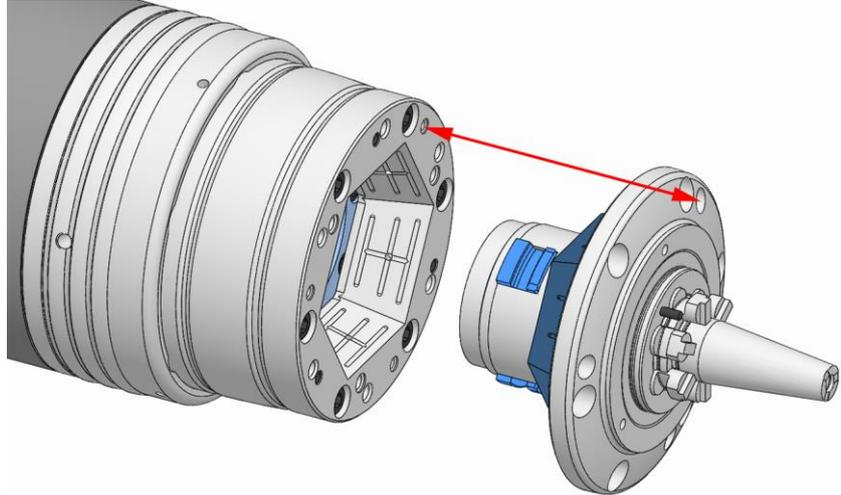
4. 基本クランプ装置の穴パターンがアダプターの形状に対応するように、アダプターを基本クランプ装置にはめ込みます。このとき、基本クランプ装置とアダプターのクランプテーパ面がぴったり合う必要があります。
