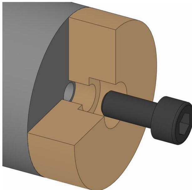
3. 換装部品の止めネジをねじ込み、規定の締め付けトルクで締めます（「ネジの締め付けトルク」の章を参照）。
