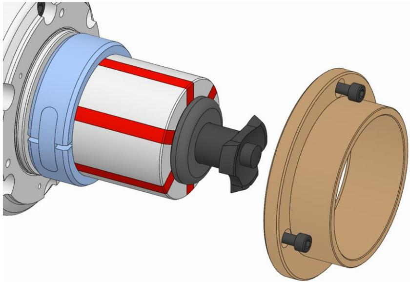
7. カップリングリングの上からテーパースリーブ/エンドストップを製品にはめ込み、固定します（「換装部品の組み付け」の章を参照）。
