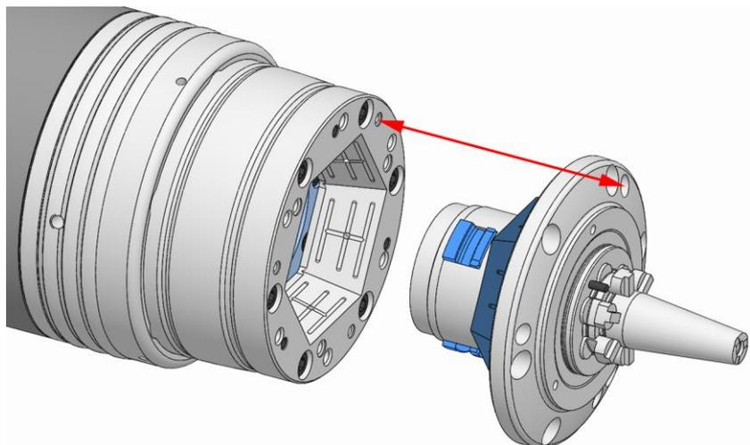
7. モジュラーシステム用アダプターを基本クランプ装置から取り外します。
