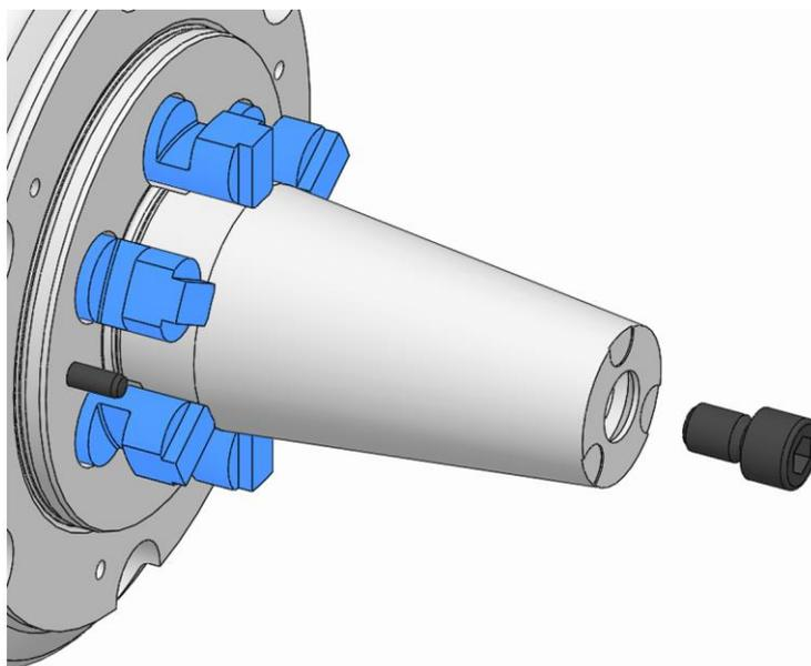
9. ロッキングスクリーを規定の締め付けトルクで締めます（「ネジの締め付けトルク」の章を参照）。
