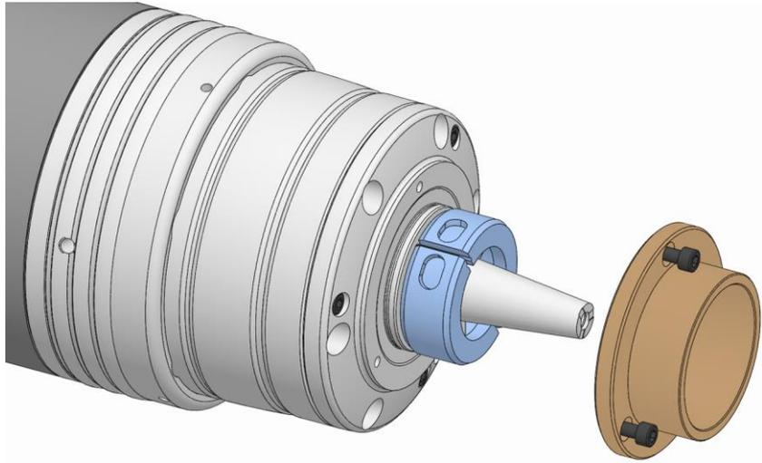
11. カップリングリングの上からテーパースリーブ/エンドストップを製品にはめ込み、固定します（「換装部品の組み付け」の章を参照）。
