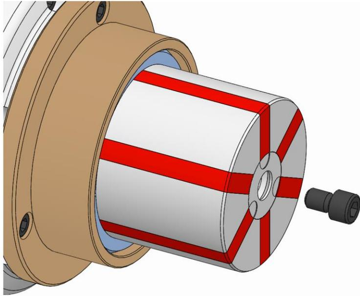
2. ロッキングスクリューを規定の締め付けトルクで締めます（「ネジの締め付けトルク」の章を参照）。
