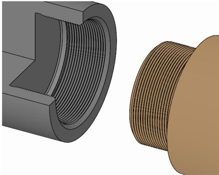
2. 換装部品のネジ溝を製品にねじ込み、締め付けます。
