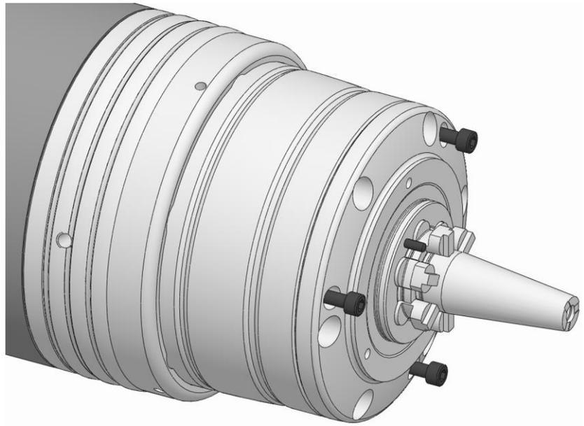
6. モジュラーシステム用アダプターの止めネジを緩め、取り外します。
