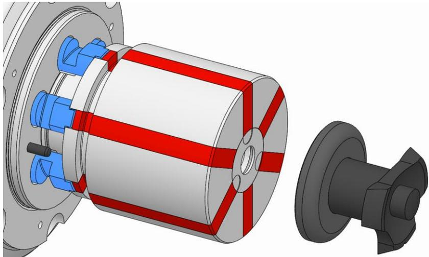
7. 場合により使用している交換ジグを緩めて取り外し、セグメントクランピングブッシュが抜け落ちないように固定します。
