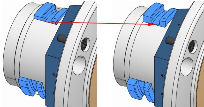
6. すべてのカップリングスライダの動きを確認します。キャップスクリーをねじ込むと、すべてのカップリングスライダがそれぞれ外側に向けて動く必要があります。
