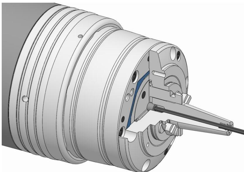
6. キャップスクリーを規定の締め付けトルクで締めます（「ネジの締め付けトルク」の章を参照）。
