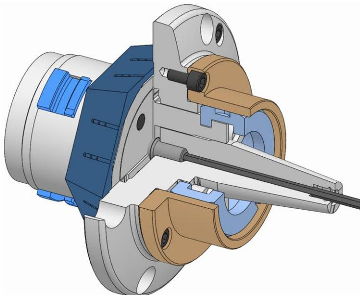
3. キャップスクリーをそれ以上回らなくなるまで回して引き出します。このとき、カップリングスライダの動きに気を付けてください。
