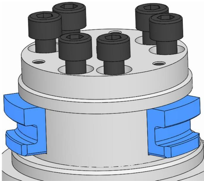
4. カップリングカバーの止めネジをねじ込み、規定の締め付けトルクで締めます（「ネジの締め付けトルク」の章を参照）。
