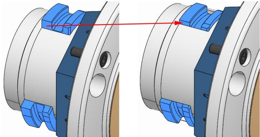
4. すべてのカップリングスライダの動きを確認します。キャップスクリューを回して引き出すと、すべてのカップリングスライダがそれぞれ内側に向けて動く必要があります。
