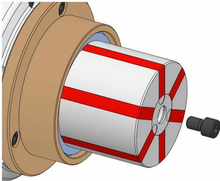
3. ロッキングスクリューを規定の締め付けトルクで締めます（「ネジの締め付けトルク」の章を参照）。
