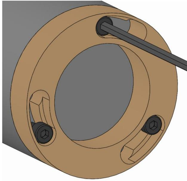
3. 換装部品の止めネジを規定の締付けトルクで締めます
