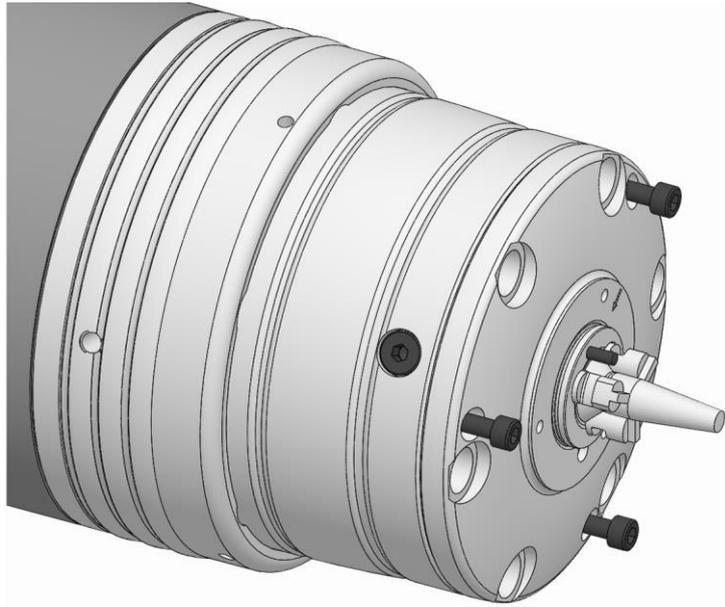
5. モジュラーシステム用アダプターの止めネジを緩め、取り外します。
