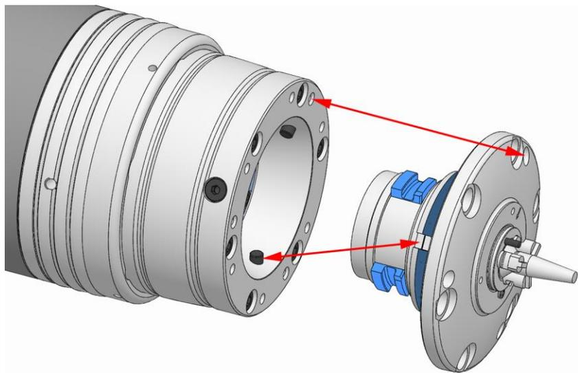
6. モジュラーシステム用アダプターを基本クランプ装置から取り外します。
