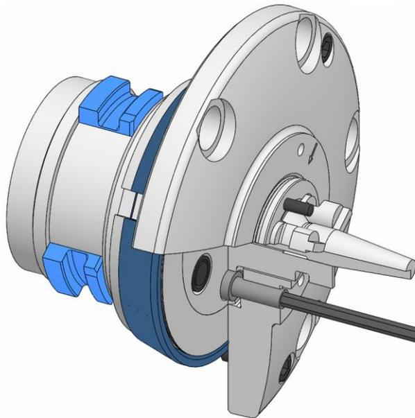
6. キャップスクリューを規定の締め付けトルクで締めます（「ネジの締め付けトルク」の章を参照）。このとき、カップリングスライダの動きに気を付けてください。
