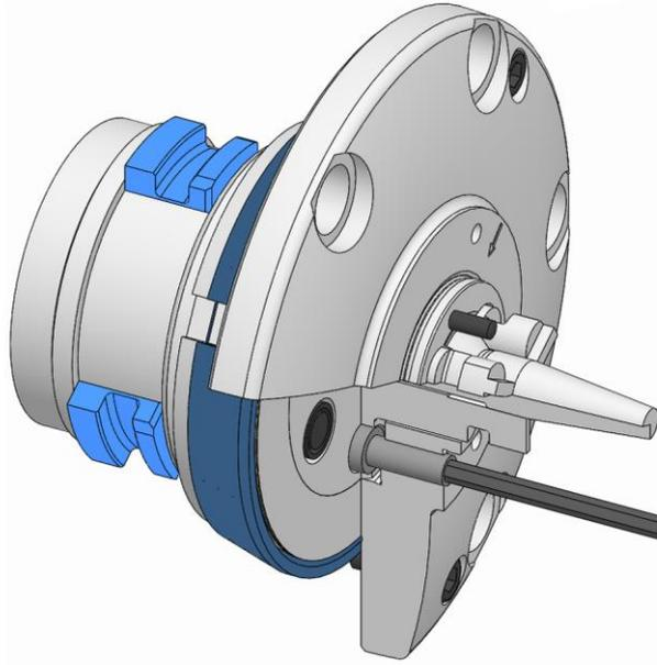
7. キャップスクリューを規定の締め付けトルクで締めます
