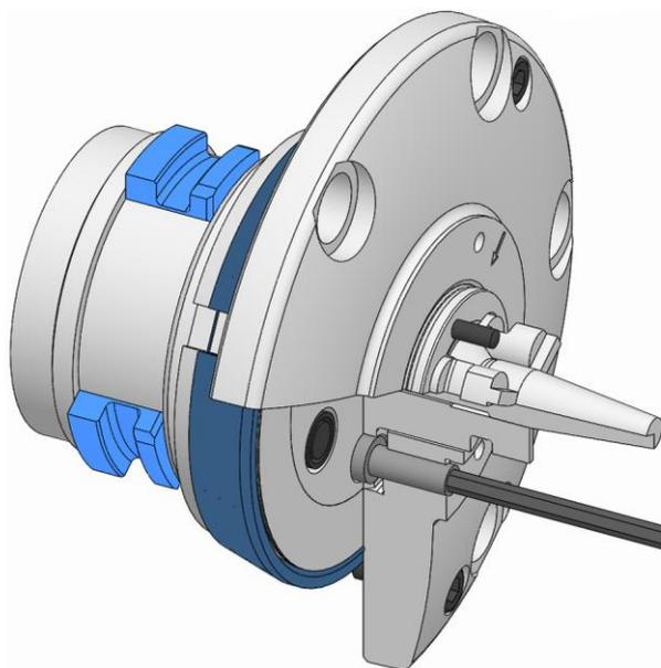
4. キャップスクリューをそれ以上回らなくなるまで回して引き出します。このとき、カップリングスライダの動きに気を付けてください。
