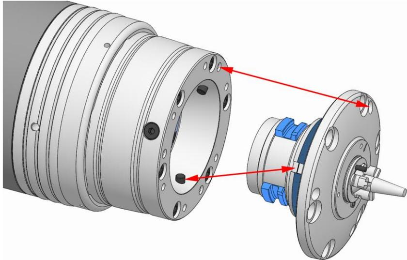
4. 基本クランプ装置の穴パターンがアダプターの形状に対応するように、アダプターを基本クランプ装置にはめ込みます。その際に、基本クランプ装置のクランプテーパの回り止めキーとモジュラーシステム用アダプターの溝が重なるようにします。
