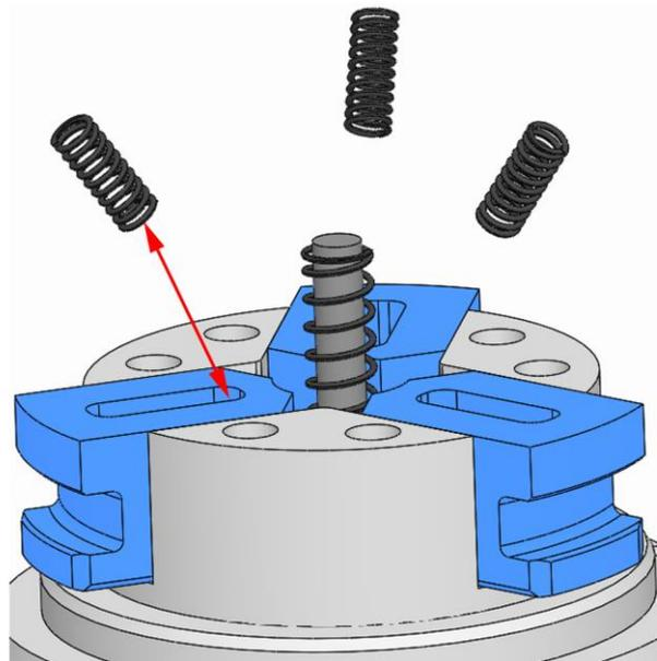
2. カップリングスライダのバネをカップリングスライダの溝に斜めに差し込み、接着性のある潤滑剤でその位置に保持します。
