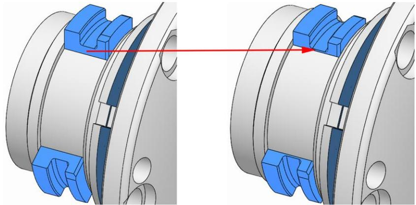
5. すべてのカップリングスライダの動きを確認します。キャップスクリューを回して引き出すと、すべてのカップリングスライダがそれぞれ内側に向けて動く必要があります。
