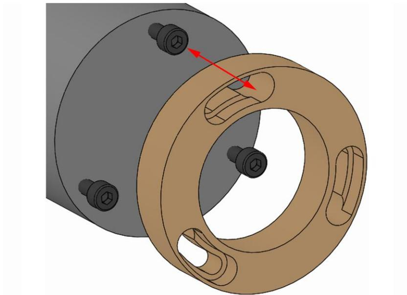
1. 換装部品の止めネジのネジ頭がバヨネット開口部に合うように、換装部品を製品に載せます。
