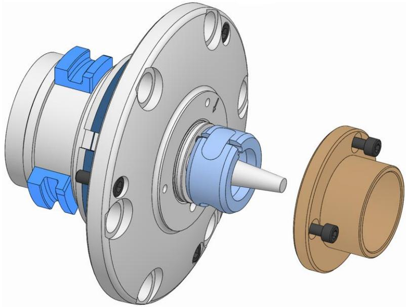
10. カップリングリングの上からテーパースリーブ/エンドストップを製品にはめ込み、固定します（「換装部品の組み付け」の章を参照）。
