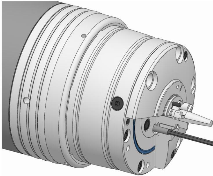
6. キャップスクリューを規定の締め付けトルクで締めます（「ネジの締め付けトルク」の章を参照）。
