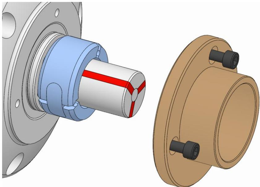
5. カップリングリングの上からテーパースリーブ/エンドストップを製品にはめ込み、固定します（「換装部品の組み付け」の章を参照）。
