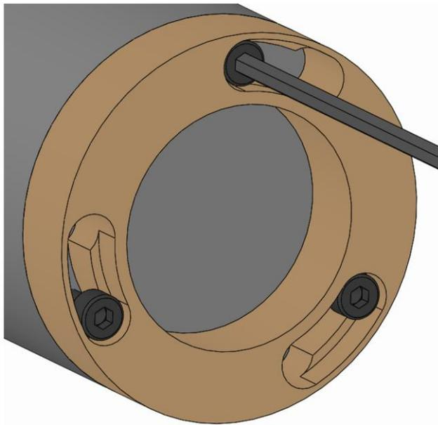
1. 換装部品の止めネジを回して、ネジが外れない程度に緩めます。
