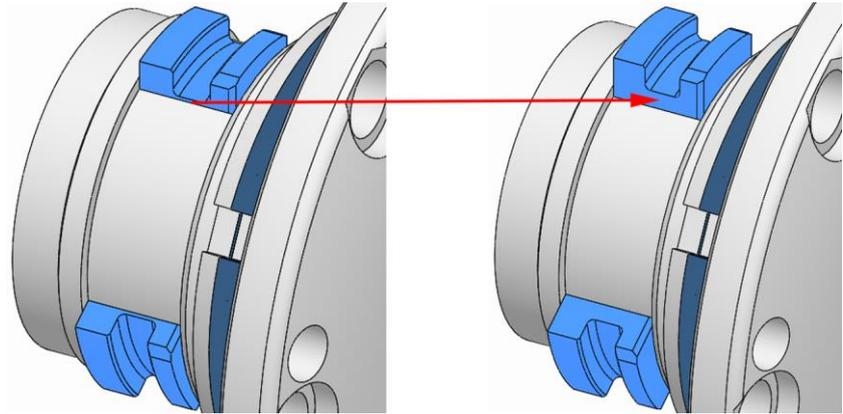
7. すべてのカップリングスライダの動きを確認します。キャップスクリューをねじ込むと、すべてのカップリングスライダがそれぞれ外側に向けて動く必要があります。
