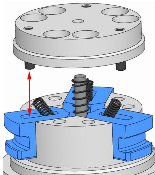
3. カップリングカバーのピンがカップリングリングの溝の位置に来るよう、カップリングカバーを同心円状に水平位置に置きます。
