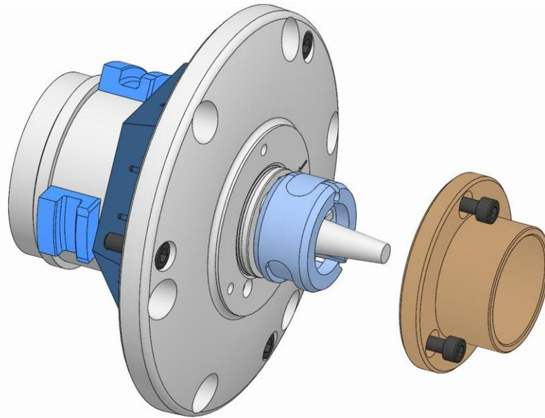
10. カップリングリングの上からテープスリーブ/エンドストップを製品にはめ込み、固定します（「換装部品の組み付け」の章を参照）。
