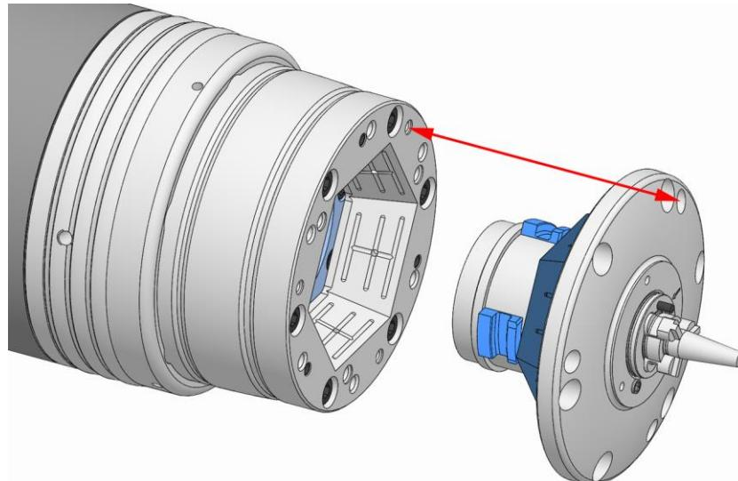
4. 基本クランプ装置の穴パターンがアダプターの形状に対応するように、アダプターを基本クランプ装置にはめ込みます。このとき、基本クランプ装置とアダプターのクランプテーパ一面がぴったり合う必要があります。
