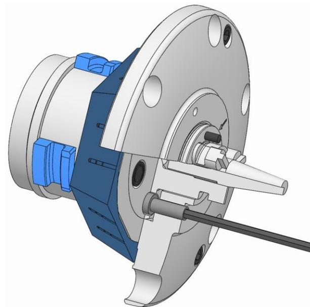
7. キャップスクリューを規定の締付けトルクで締めます（「ネジの締め付けトルク」の章を参照）。
