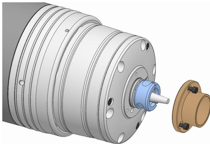
10. カップリングリングの上からテーパースリーブ/エンドストップを製品にはめ込み、固定します（「換装部品の組み付け」の章を参照）。
