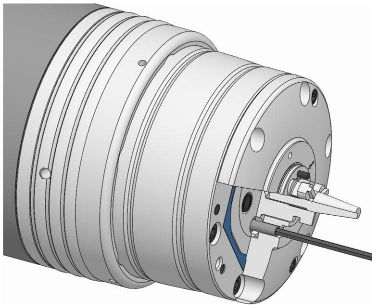
6. キャップスクリューを規定の締付けトルクで締めます（「ネジの締め付けトルク」の章を参照）。
