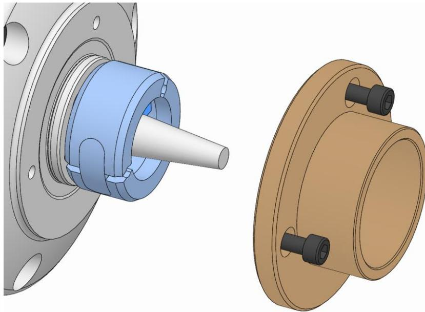
7. カップリングリングの上からテーパースリーブ/エンドストップを製品にはめ込み、固定します（「換装部品の組み付け」の章を参照）。
