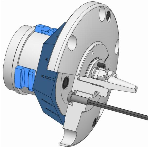
6. キャップスクリューを規定の締付けトルクで締めます（「ネジの締め付けトルク」の章を参照）。このとき、カップリングスライダの動きに気を付けてください。
