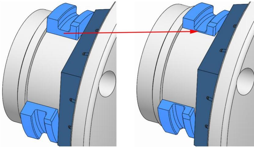
5. すべてのカップリングスライダの動きを確認します。キャップスクリューを回して引き出すと、すべてのカップリングスライダがそれぞれ内側に向けて動く必要があります。
