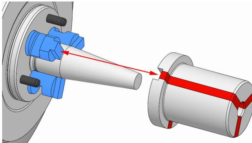
3. セグメントクランピングブッシュを製品に嵌め、抜け落ちないようにします。このとき、セグメントクランピングブッシュのスリットがカップリングの突起に咬み合っていなければなりません。
