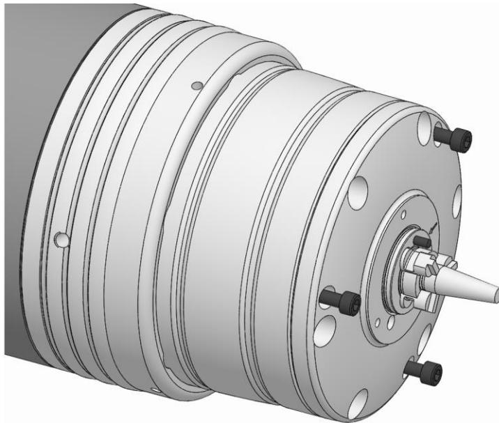
5. モジュラーシステム用アダプターの止めネジを緩め、取り外します。
