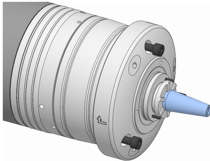
7. モジュラーシステム用アダプターの止めネジをねじ込み、規定の締付けトルクで締めます（「ネジの締め付けトルク」の章を参照）。
