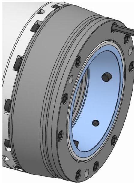
4. アダプターリングの止めネジを規定の締付けトルクで締めます（「ネジの締め付けトルク」の章を参照）。
