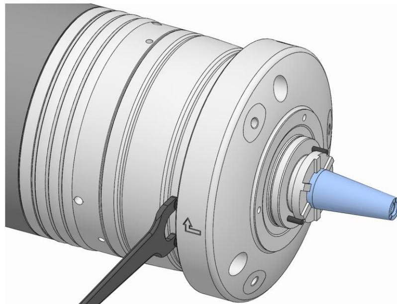
5. 基本クランプ装置と穴パターンがアダプターの形状に一致するように、モジュラーシステム用アダプターを基本クランプ装置側に突き当たるまで矢印方向に回すか、または基本クランプ装置を使用してスピンドルをアダプター側に突き当たるまで矢印とは逆方向に回します。
