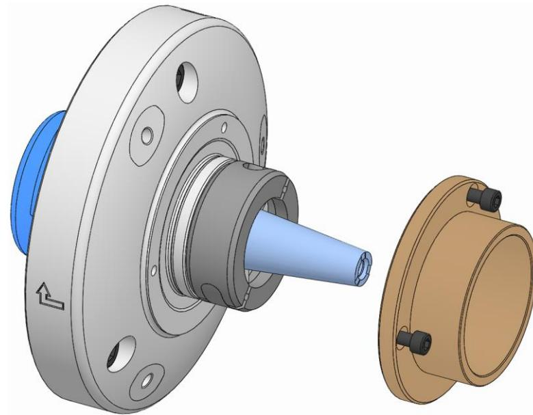
9. カップリングリングの上からテープースリーブ/エンドストップを製品にはめ込み、固定します（「換装部品の組み付け」の章を参照）。
