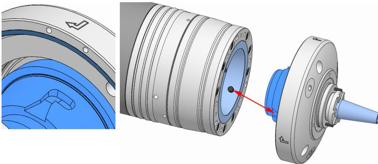
4. 基本クランプ装置にモジュラーシステム用アダプターを置きます。その際に、基本クランプ装置のクランプテーパーの回り止めキーとモジュラーシステム用アダプターの溝が重なるようにします。
