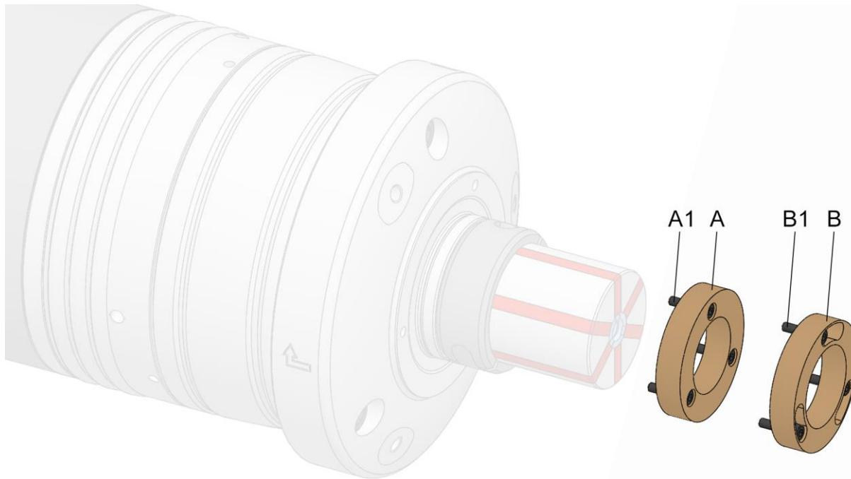
A 換装部品を側面から x 箇所、ネジで固定する
