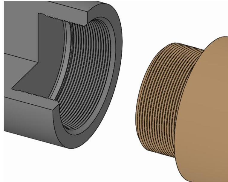
1. 換装部品のネジ溝を製品にねじ込み、締め付けます。
