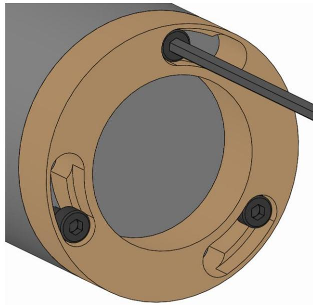
3. 換装部品の止めネジを規定の締付けトルクで締めます
