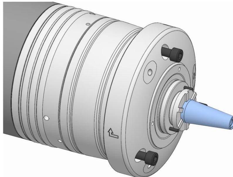
4. モジュラーシステム用アダプターの止めネジを緩め、取り外します。
