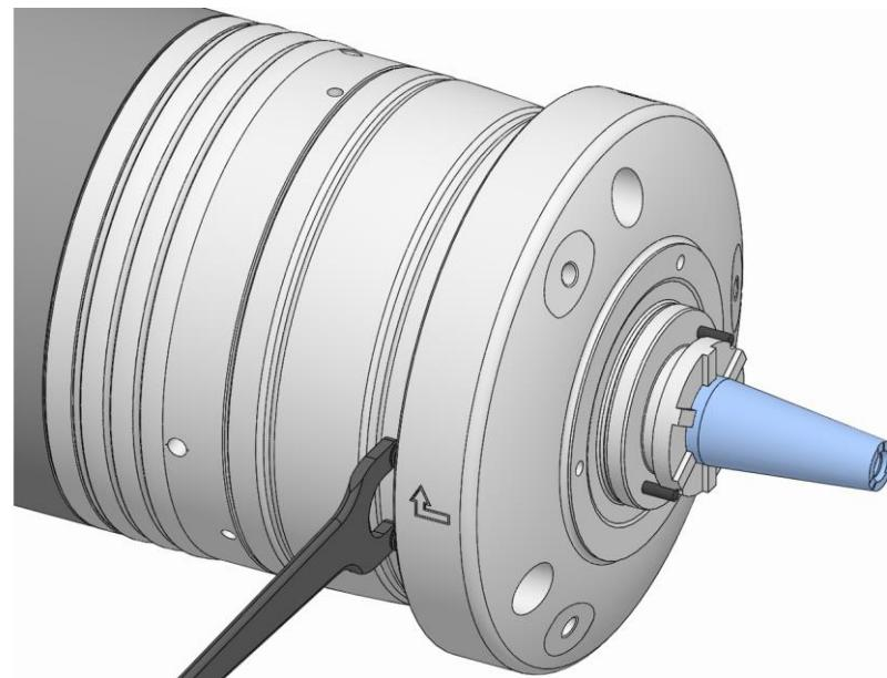
6. モジュラーシステム用アダプターを基本クランプ装置側に突き当たるまで矢印とは逆方向に回すか、または基本クランプ装置を使用してスピンドルをアダプター側に突き当たるまで矢印方向に回します。
