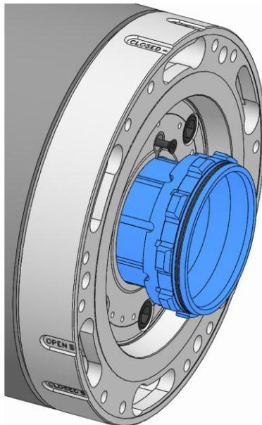
6. 回転方向位置決めキーの締めネジをねじ込み、このネジを規定締め付けトルクで締め付けてください[「ボルト締めつけトルク」の章参照]。
