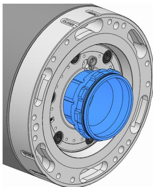
5. 回転方向位置決めキーをバヨネットドロチューブアダプターの溝に入れ、スピンドル法兰ジの溝に入れます。
