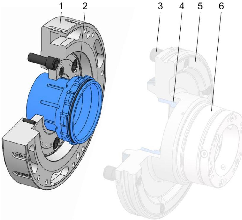
クイックチェンジシステムで工作機械をコレットチャック / チャック別にすぐ段取り替えできます。
