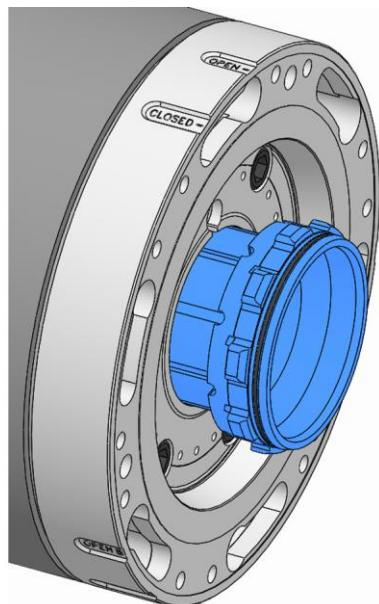
3. バヨネットドロチューブアダプターとスピンドル法兰ジの溝が合うまで、バヨネットドロチューブアダプターを回します。
