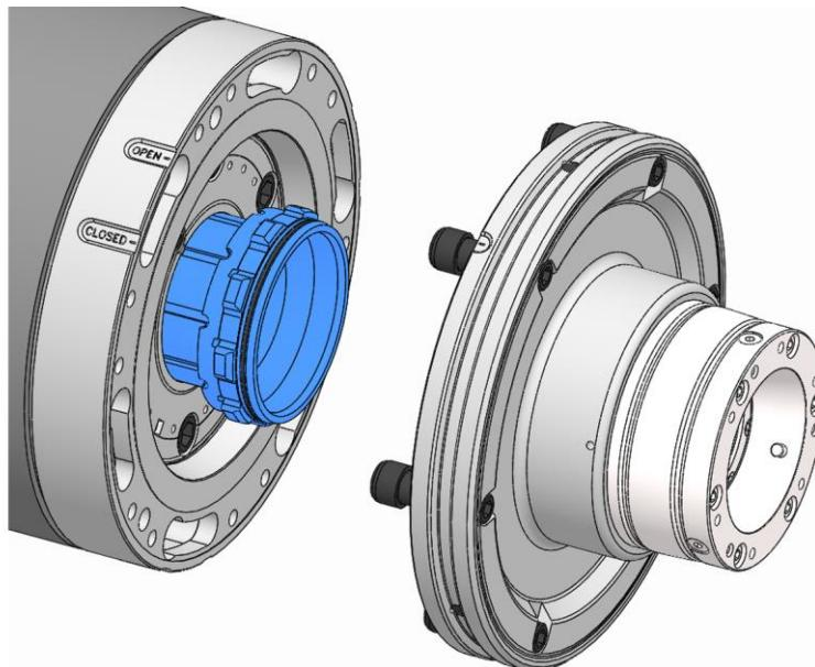
6. クイックチェンジユニットを中間アダプテーションフランジに合わせ、クイックチェンジユニットと中間アダプテーションフランジの»OPEN«マークを一致させます。
