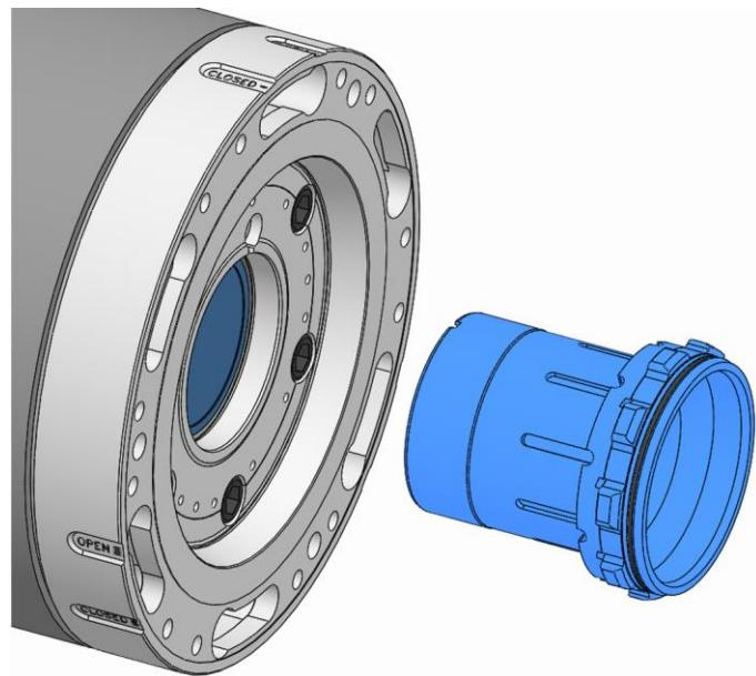
4. バヨネットドロチューブアダプターを機械のドロチューブから取り外します。
