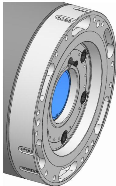
6. 回転方向位置決めキーの締めネジをねじ込み、このネジを規定締め付けトルクで締め付けてください[「ボルト締めつけトルク」の章参照]。
