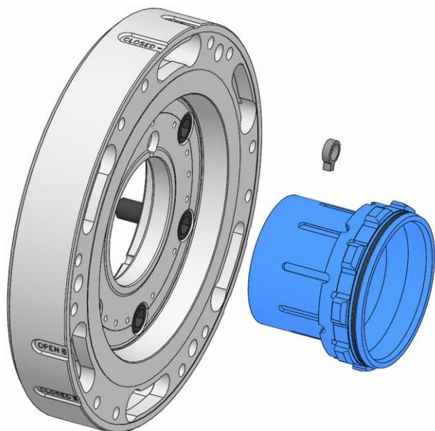
2. バヨネットドロチューブアダプターと回転方向位置決めキーをスピンドルフランジから抜き取ります。
