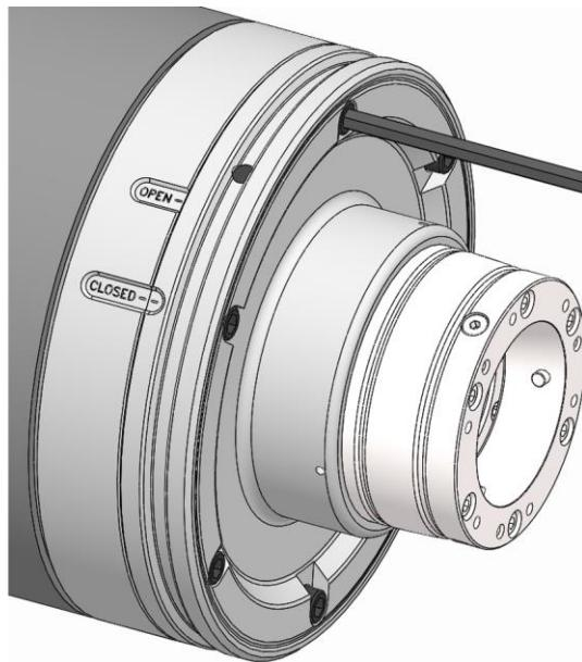
5. クイックチェンジユニットのクイックロックボルトを数回回して緩めますが、取り外しません。
