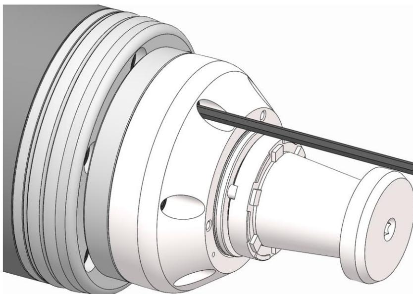
6. クイックチェンジユニットの止めネジを規定の締め付けトルクで締めます（「ネジの締め付けトルク」の章を参照してください）。
