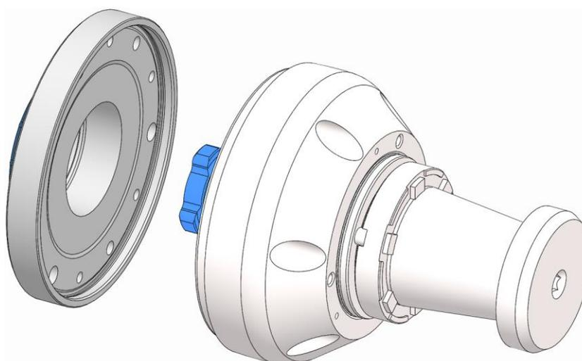
4. コレットチャックの穴あけパターンとフランジの位置が一致するように、コレットチャックをフランジに配置します。
