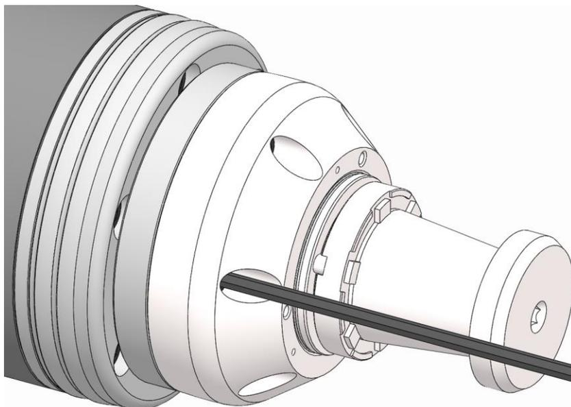
3. コレットチャックの固定ネジを緩めた状態で、軽く装着します。
