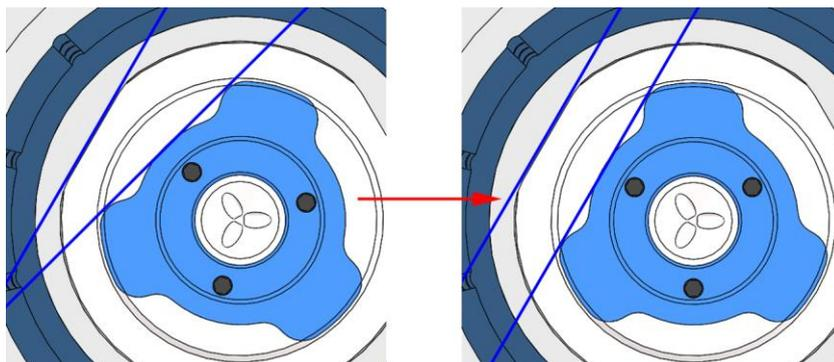
8. バヨネットラグ間の仮想線とフランジの表面の線とが平行になるまで、バヨネットカップラーを元に戻します。
