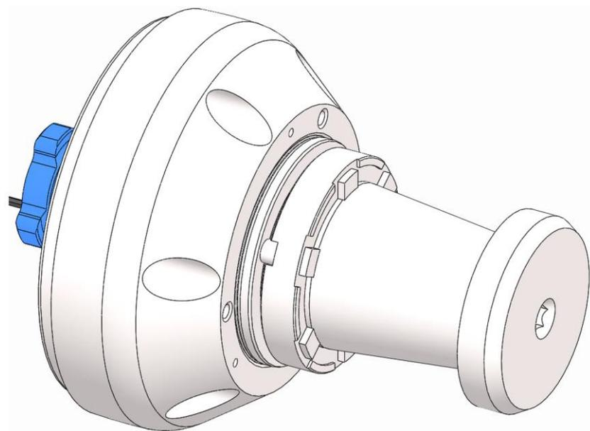
3. バヨネットカップラーの締め付けネジを数回転ほど回して、ネジが外れない程度に緩めます。
