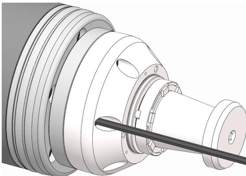
5. コレットチャックの止めネジを規定の締め付けトルクで締めます（「ネジの締め付けトルク」の章を参照してください）。
