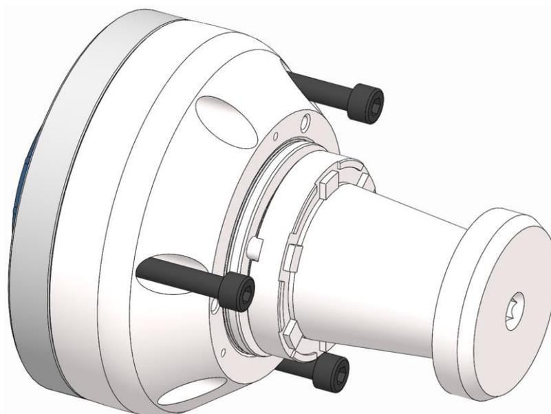
1. コレットチャックの固定ネジを緩めて取り外します。
