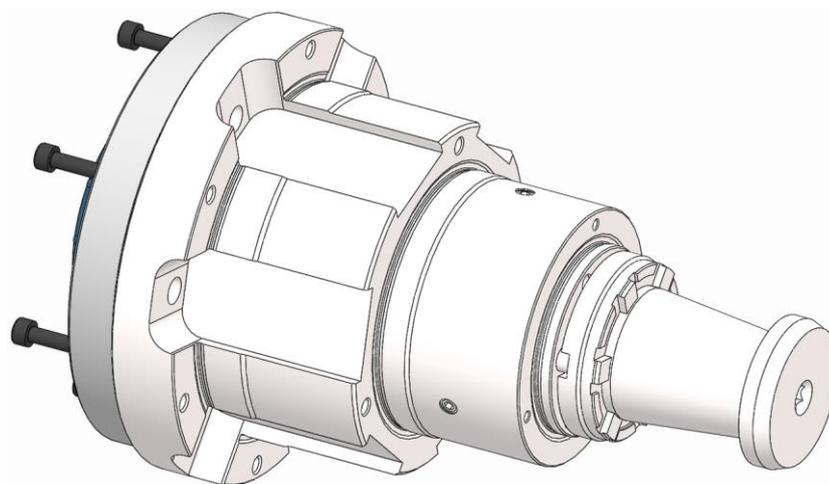
8. コレットチャックの止めネジをねじ込み、軽く固定します。
