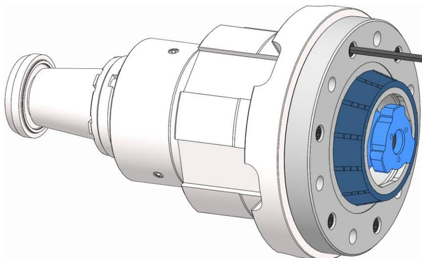
13. コレットチャックの止めネジを規定の締め付けトルクで締めます（「ネジの締め付けトルク」の章を参照してください）。
