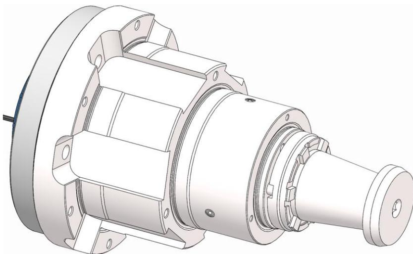
10. バヨネットカップラーの締め付けネジをねじ込み、規定の締め付けトルクで締めます（「ネジの締め付けトルク」の章を参照してください）。
