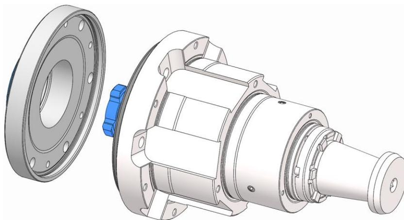
2. コレットチャックをリングアダプターセットと一緒にフランジから取り外します。その際には、リングアダプターセットが落下しないように固定します。
