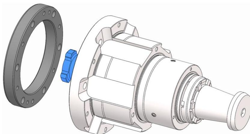
5. リングアダプターセットをコレットチャックに設置して、落下しないように固定します。
