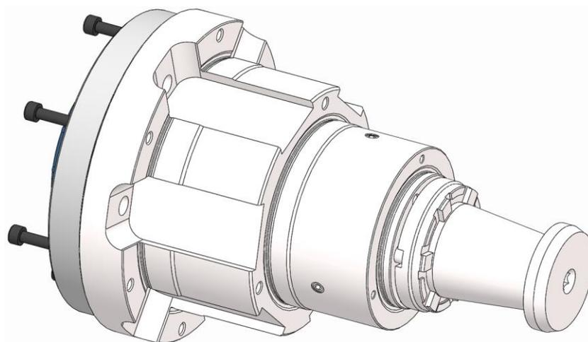
1. コレットチャックの固定ネジを緩めて取り外します。
