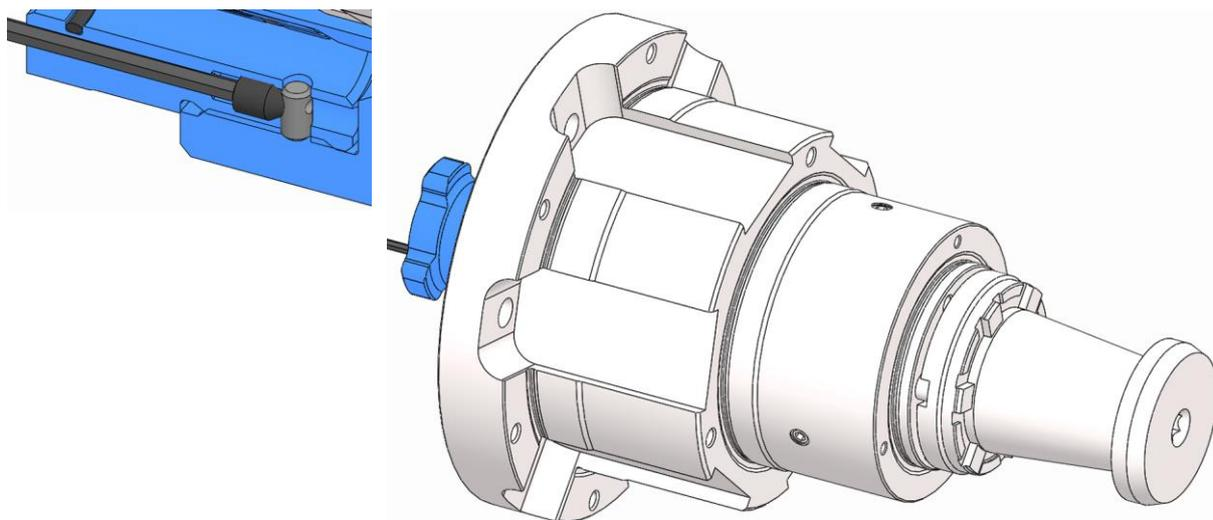
4. バヨネットカプラーの締め付けネジのひとつを軽く締めます[締め付けトルクは約 3 Nm]。
