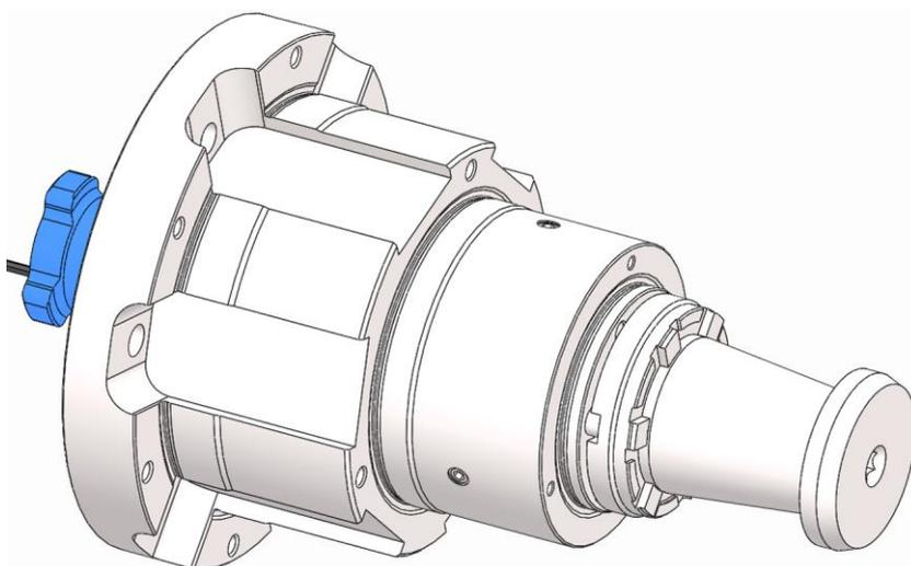
4. バヨネットカップラーの締め付けネジを数回転ほど回して、ネジが外れない程度に緩めます。
