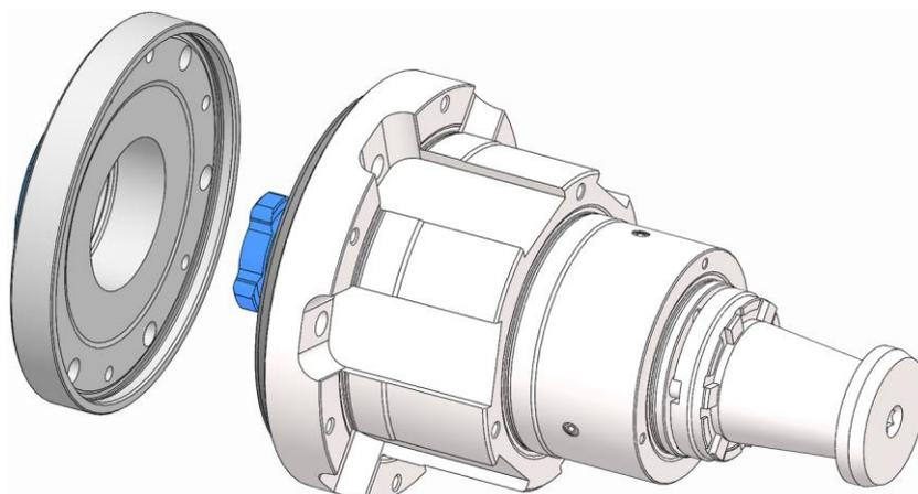
6. コレットチャックとリングアダプターセットの穴あけパターンとフランジの位置が一致するように、コレットチャックとリングアダプターセットをフランジに配置します。
