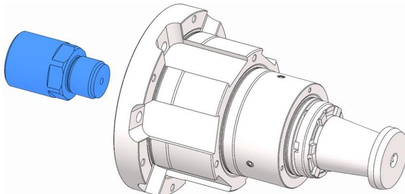
1. アダプターセットをコレットチャックにねじ込み、締付けます。
