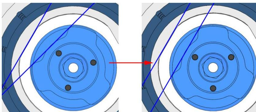
9. バヨネットラグ間の仮想線とフランジの表面の線とが平行になるまで、バヨネットカップラーを元に戻します。
