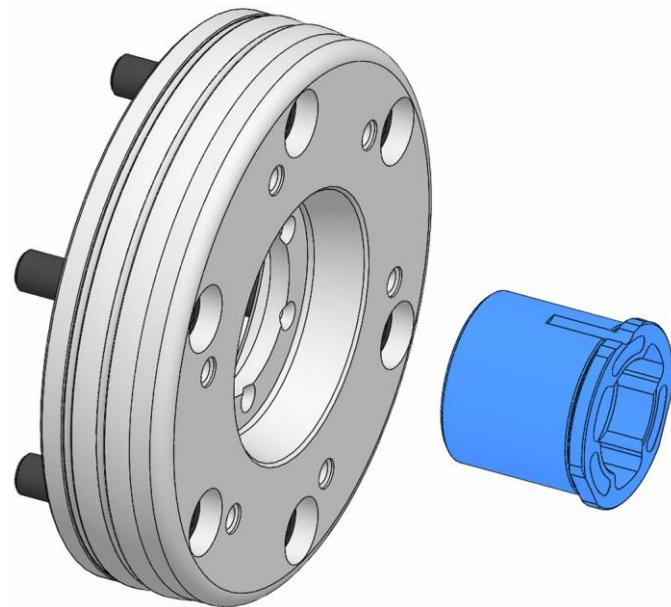
2. バヨネットドロチューブアダプターをスピンドルフランジから抜き取ります。
