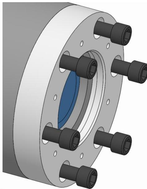
4. スピンドルフランジの止めネジをねじ込み、軽く固定します。
