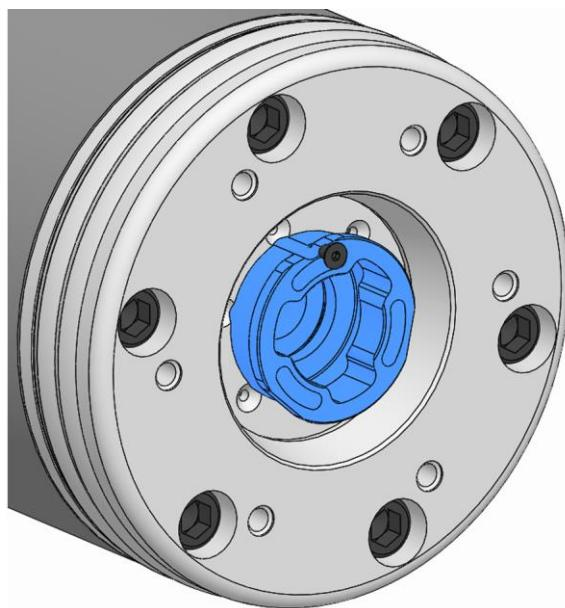
5. バヨネットドロチューブアダプター回転方向位置決めキーをねじ込み、このネジを規定締め付けトルクで締め付けてください[「ボルト締めつけトルク」の章を参照してください]。
