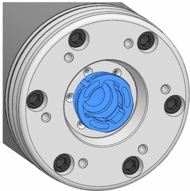
3. バヨネットチューブアダプターの回転方向位置決めキーのスピンドルフランジの最も近い穴とバヨネットチューブアダプターの溝の位置が一致するまで、バヨネットチューブアダプターを回します。
