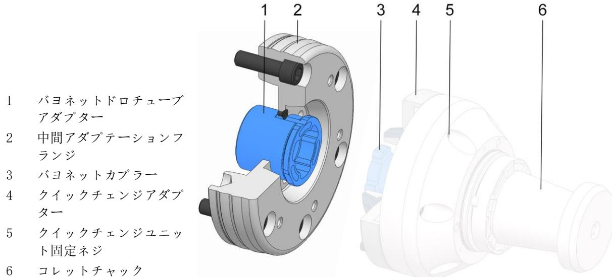
クイックチェンジシステムで工作機械をコレットチャック / チャック別にすぐ段取り替えできます。
