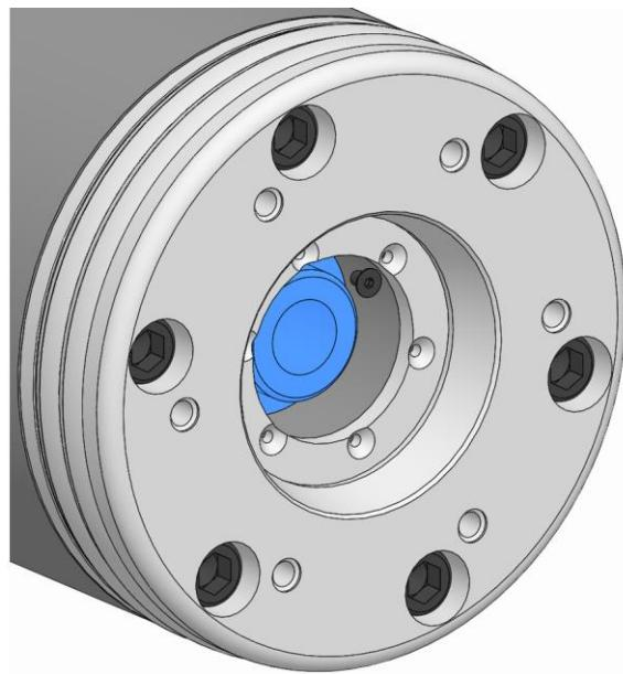
4. バヨネットドロチューブアダプター回転方向位置決めキーをねじ込み、このネジを規定締め付けトルクで締め付けてください[「ボルト締めつけトルク」の章を参照してください]。
