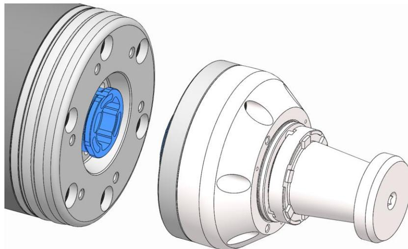
6. クイックチェンジユニットと中間アダプテーションフランジは、クイックチェンジユニットのバヨネットラグと、中間アダプテーションフランジのバヨネット開口部の位置が一致するように配置します。
