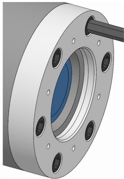
8. スピンドルフランジの止めネジを規定の締付けトルクで締めます（「ネジの締め付けトルク」の章を参照）。
