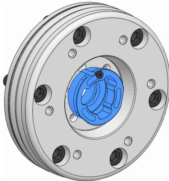
1. バヨネットドロチューブアダプター回転方向位置決めキーを緩めて取り外します。
