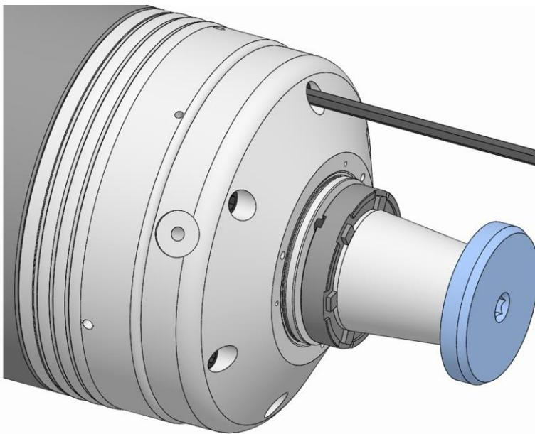
11. 機能ユニットの止めネジを規定の締付けトルクで締めます（「ネジの締め付けトルク」の章を参照）。
