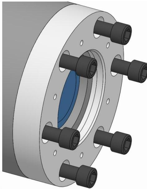
4. スピンドルフランジの止めネジをねじ込み、規定の締付けトルクで締めます（「ネジの締め付けトルク」の章を参照）。
