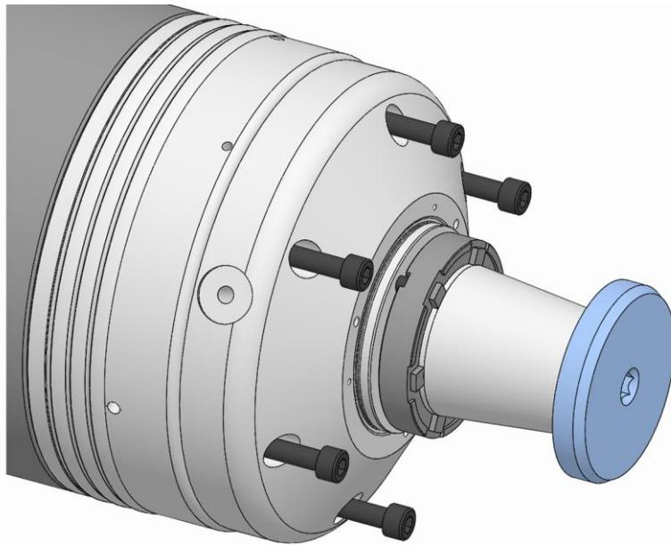
7. 機能ユニットの止めネジをねじ込み、規定の締付けトルクで締めます（「ネジの締め付けトルク」の章を参照）。
