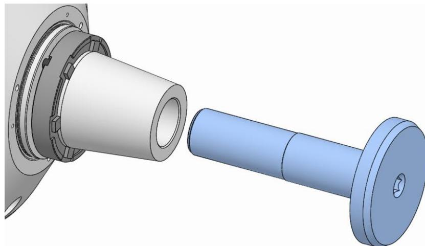
3. ドローボルトを緩め、取り外します。その際、イジェクターが抜け落ちないようにしてください。
