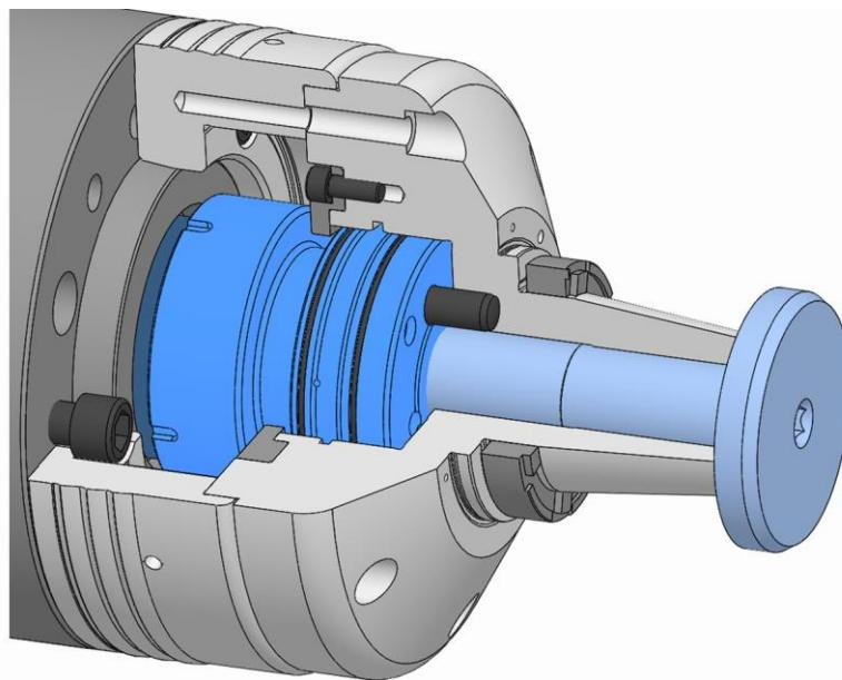
5. スピンドルフランジの穴パターンと機能ユニットの形状が一致するまで、機能ユニットを回して戻します。
