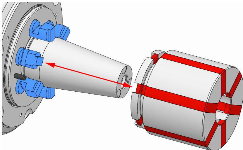
3. セグメントクランピングブッシュを製品に嵌め、抜け落ちないようにします。このとき、セグメントクランピングブッシュのスリットがカップリングの突起に咬み合っていなければなりません。
