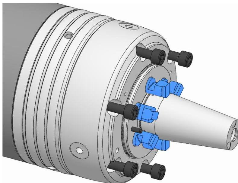
7. 機能ユニットの止めネジをねじ込み、軽く固定します。
