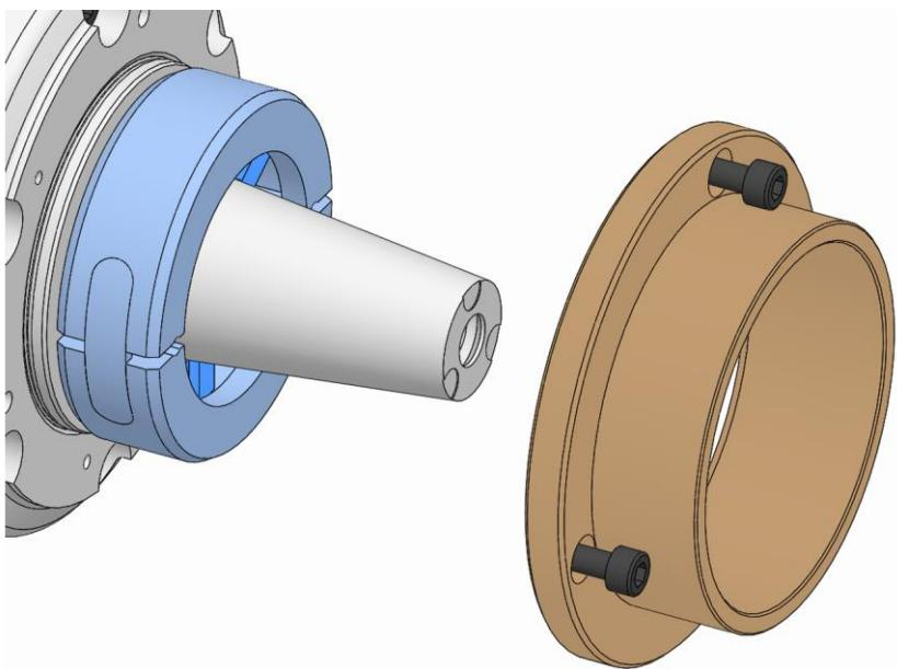
9. カップリングリングの上からテープスリーブ/エンドストップを製品にはめ込み、固定します（「換装部品の組み付け」の章を参照）。
