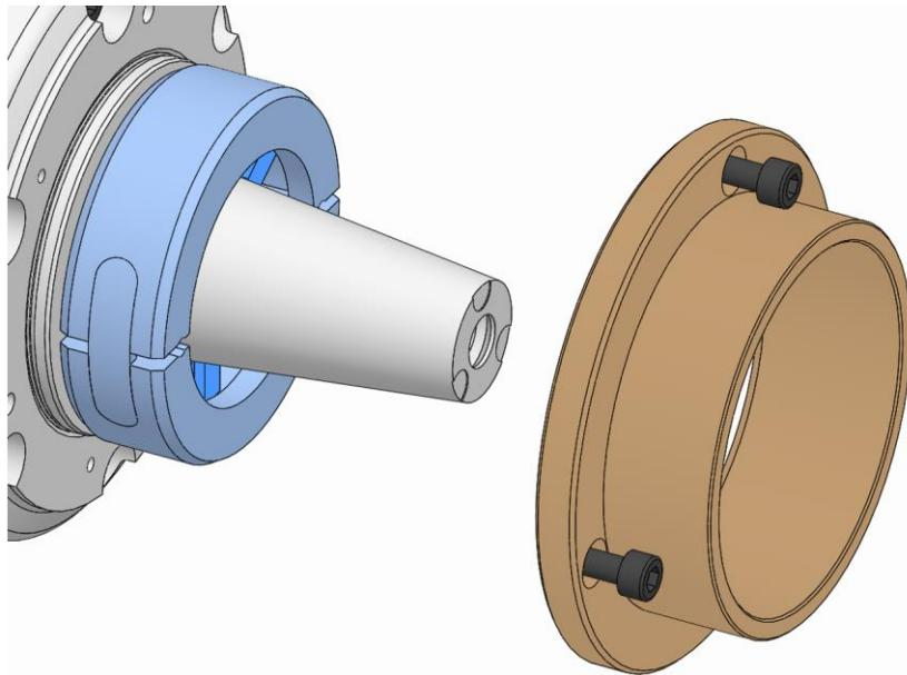
3. カップリングリングの上からテープスリーブ/エンドストップを製品にはめ込み、固定します（「換装部品の組み付け」の章を参照）。
