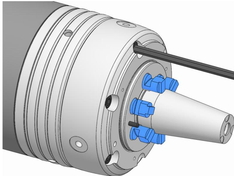
11. 機能ユニットの止めネジを規定の締付けトルクで締めます（「ネジの締め付けトルク」の章を参照）。
