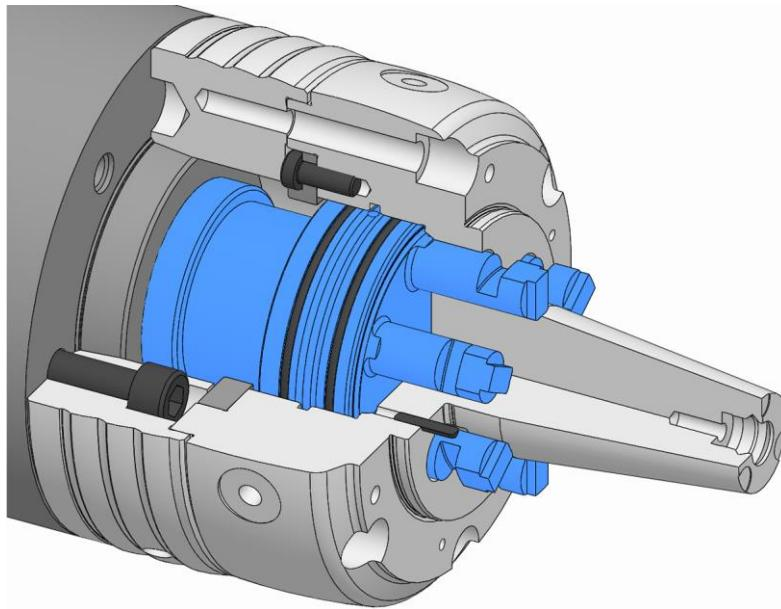
5. スピンドルフランジの穴パターンと機能ユニットの形状が一致するまで、機能ユニットを回して戻します。
