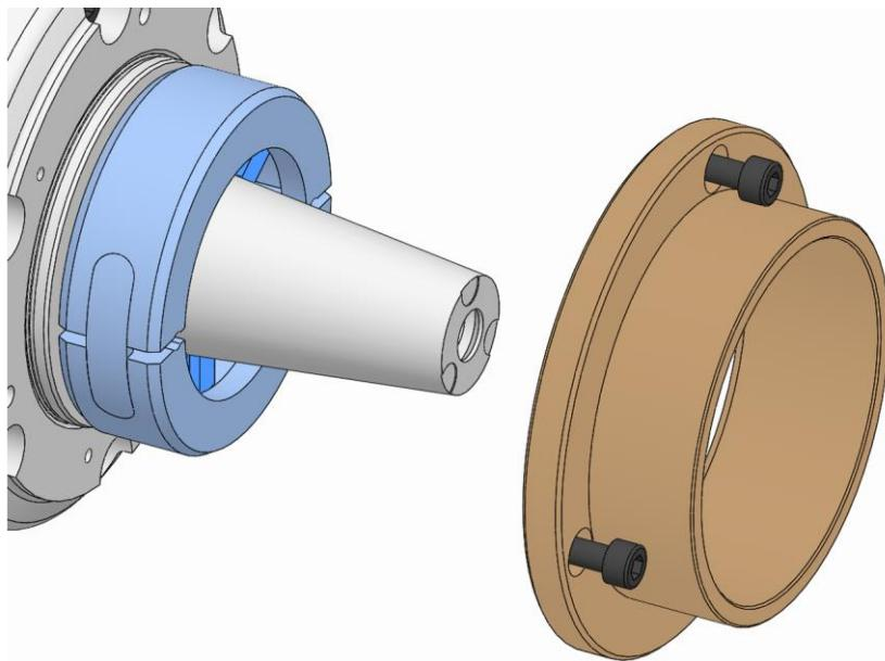
3. カップリングリングの上からテーパースリーブ/エンドストップを製品にはめ込み、固定します（「換装部品の組み付け」の章を参照）。
