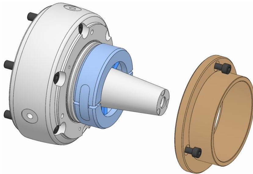
8. カップリングリングの上からテーパースリーブ/エンドストップを製品にはめ込み、固定します（「換装部品の組み付け」の章を参照）。
