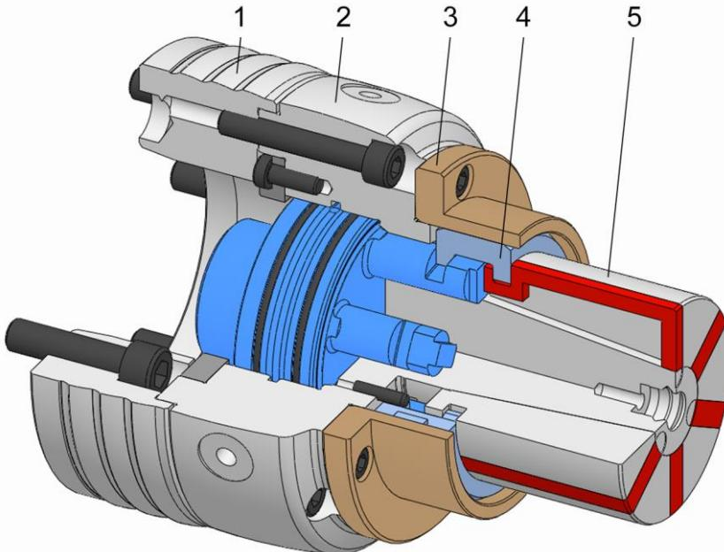
スピンドル法兰ジは機械のスピンドルに取り付けます。コレットチャックはドローチューブアダプターを介して工作機械のドローチューブにねじ込み、スピンドル法兰ジで締め付けます。
