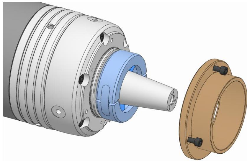
20. カップリングリングの上からテープスリーブ/エンドストップを製品にはめ込み、固定します（「換装部品の組み付け」の章を参照）。
