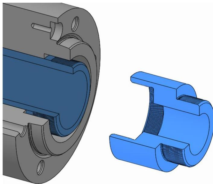
1. 機械のドローバーにドローチューブアダプターが取り付けられていた場合は、アダプターのネジ溝を回して、アダプターを機械のドローバーから取り外します。
