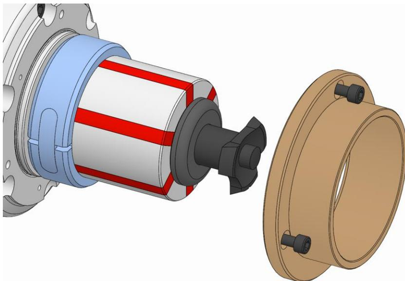
6. カップリングリングの上からテーパースリーブ/エンドストップを製品にはめ込み、固定します（「換装部品の組み付け」の章を参照）。
