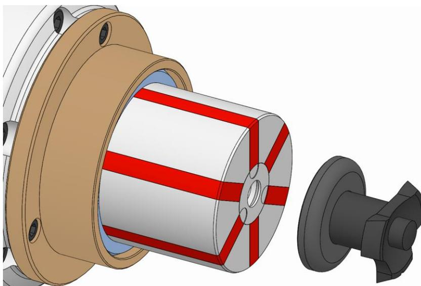
7. 場合により使用している交換ジグを緩め、取り外します。
