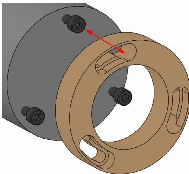
1. 換装部品の止めネジのネジ頭がバヨネット開口部に合うように、換装部品を製品に載せます。
