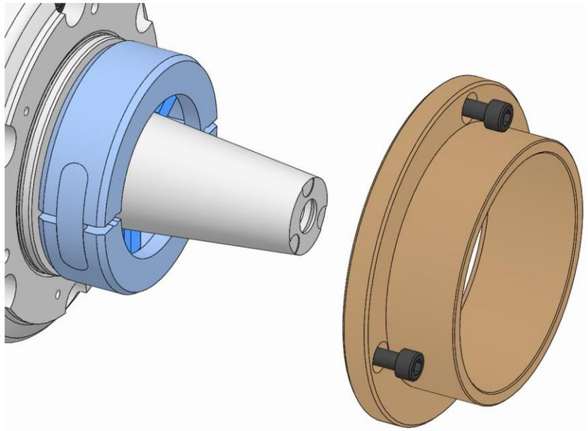
9. カップリングリングの上からテーパースリーブ/エンドストップを製品にはめ込み、固定します（「換装部品の組み付け」の章を参照）。
