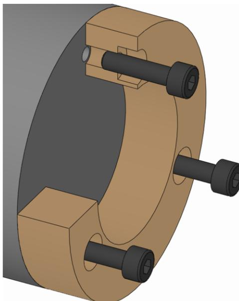
2. 換装部品の止めネジをねじ込み、規定の締付けトルクで締めます（「ネジの締め付けトルク」の章を参照）。
