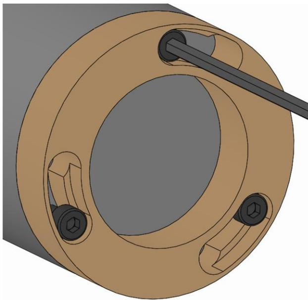
3. 換装部品の止めネジを規定の締め付けトルクで締めます（「ネジの締め付けトルク」の章を参照）。
