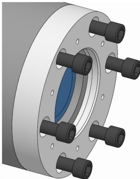
4. スピンドルフランジの止めネジをねじ込み、規定の締め付けトルクで締めます（「ネジの締め付けトルク」の章を参照）。
