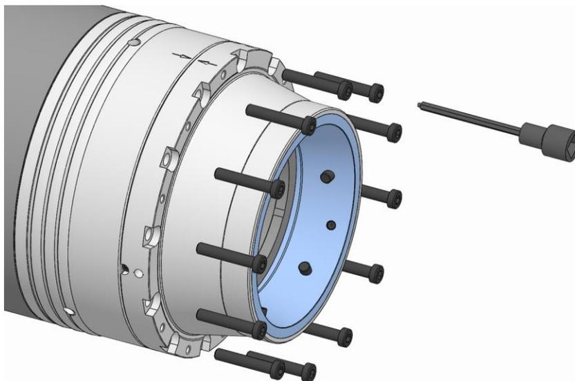
4. 機能ユニットの止めネジを刃先ガイド付きドライバービットで緩め、取り外します。
