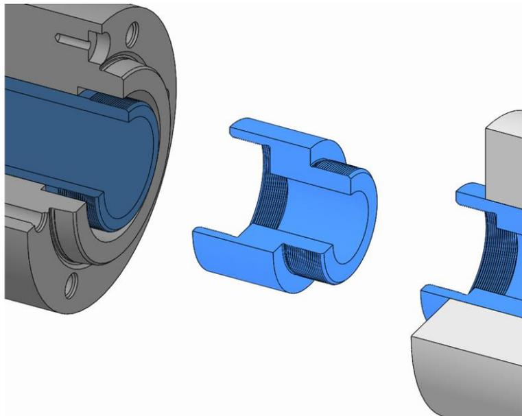
1. ドローチューブアダプターはアダプターのねじ溝によって機能ユニットにねじ込むか、機械のドローバーにねじ止めして締め付けます。
