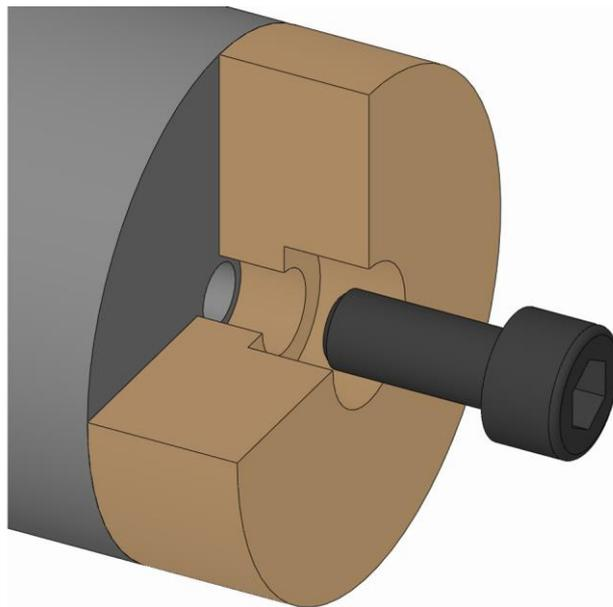
2. 換装部品の止めネジをねじ込み、規定の締め付けトルクで締めます（「ネジの締め付けトルク」の章を参照）。
