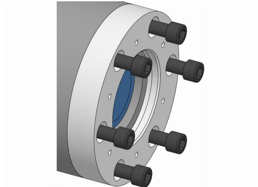
4. スピンドルフランジの止めネジをねじ込み、軽く固定します。
