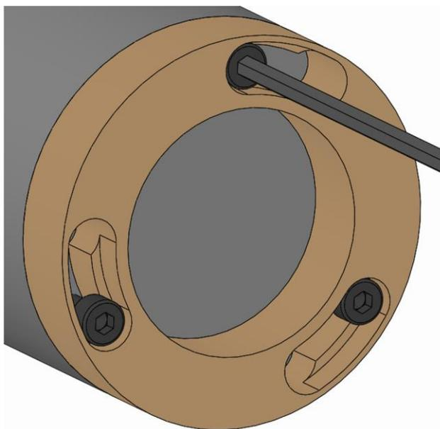
3. 換装部品の止めネジを規定の締め付けトルクで締めます
