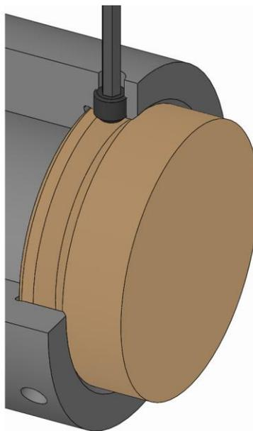
2. 換装部品の締め付けネジをねじ込み、規定の締め付けトルクで締めます（「ネジの締め付けトルク」の章を参照）。
