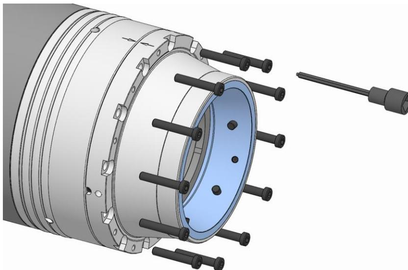
7. 機能ユニットの止めネジを刃先ガイド付きドライバービットでねじ込み、規定の締め付けトルクで締めます（「ネジの締め付けトルク」の章を参照）。
