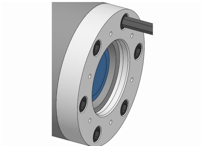
8. スピンドルフランジの止めネジを規定の締め付けトルクで締めます（「ネジの締め付けトルク」の章を参照）。
