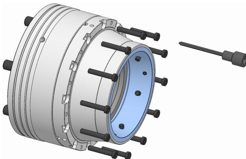
2. 機能ユニットの止めネジを刃先ガイド付きドライバービットで緩め、取り外します。
