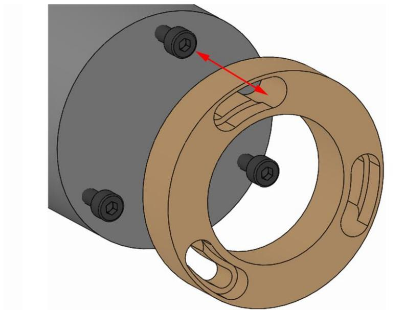
1. 換装部品の止めネジのネジ頭がバヨネット開口部に合うように、換装部品を製品に載せます。
