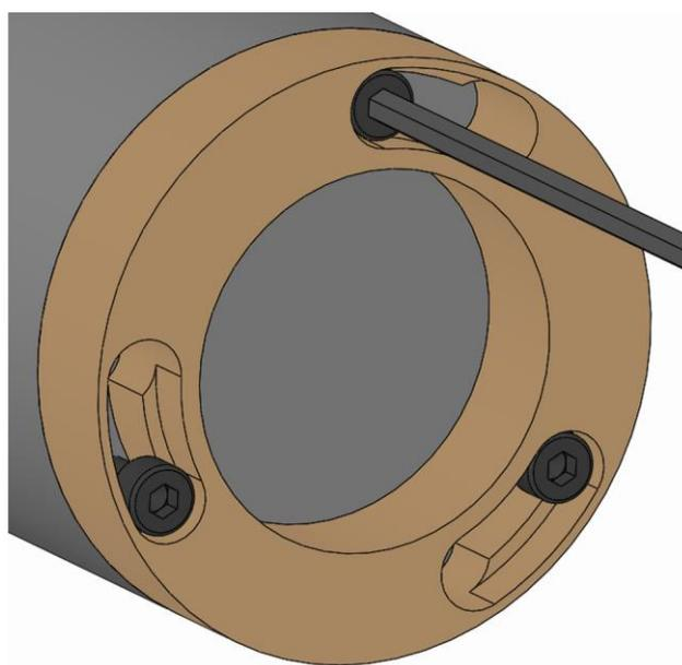
1. 換装部品の止めネジを回して、ネジが外れない程度に緩めます。
