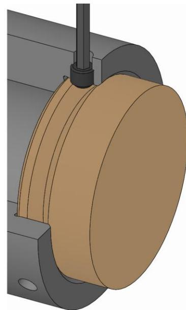
1. 換装部品を取り外せるようになるまで、換装部品の締め付けネジを緩めます。
