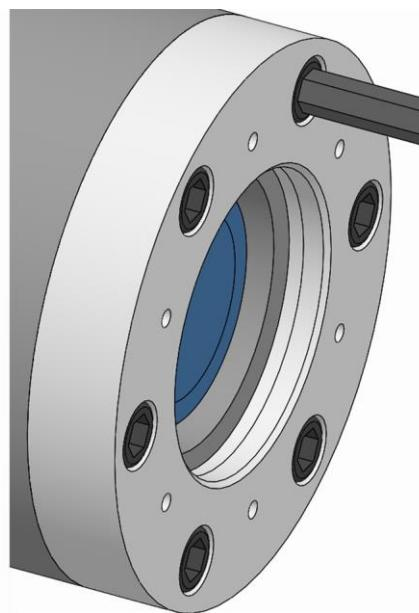
8. スピンドルフランジの止めネジを規定の締付けトルクで締めます（「ネジの締め付けトルク」の章を参照）。
