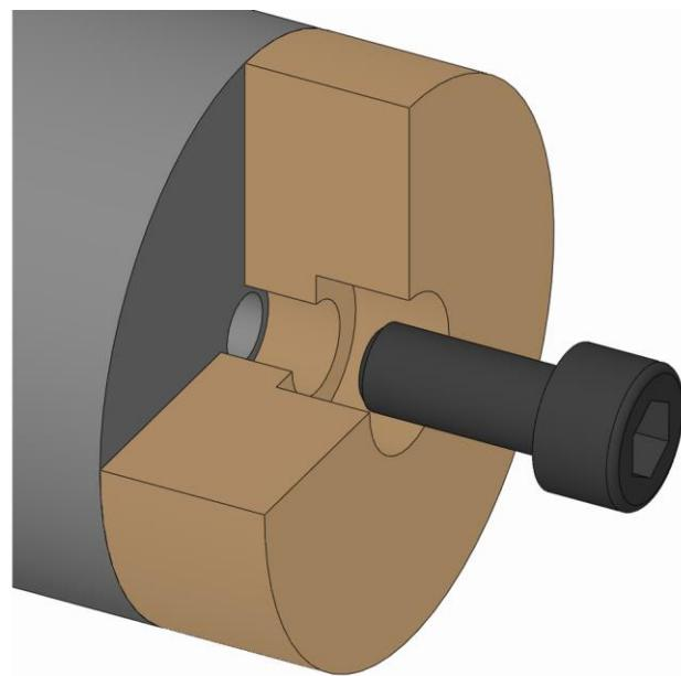
2. 換装部品の止めネジをねじ込み、規定の締付けトルクで締めます（「ネジの締め付けトルク」の章を参照）。
