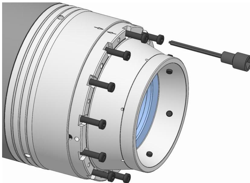
4. 機能ユニットの止めネジを刃先ガイド付きドライバービットで緩め、取り外します。
