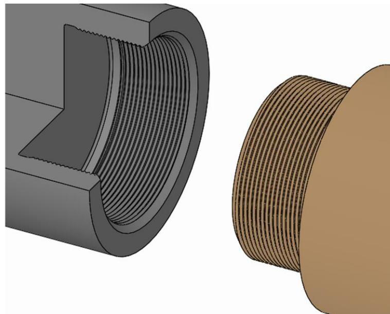
1. 換装部品のネジ溝を製品にねじ込み、締め付けます。
