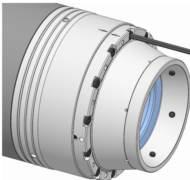
11. 機能ユニットの止めネジを刃先ガイド付きドライバービットにより、規定の締付けトルクで締め付けます（「ネジの締め付けトルク」の章を参照）。
