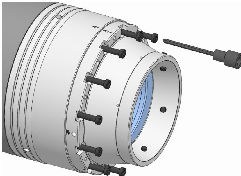
7. 機能ユニットの止めネジを刃先ガイド付きドライバービットでねじ込み、軽くはめます。
