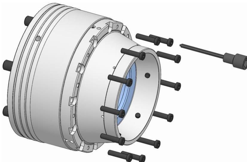
2. 機能ユニットの止めネジを刃先ガイド付きドライバービットで緩め、取り外します。
