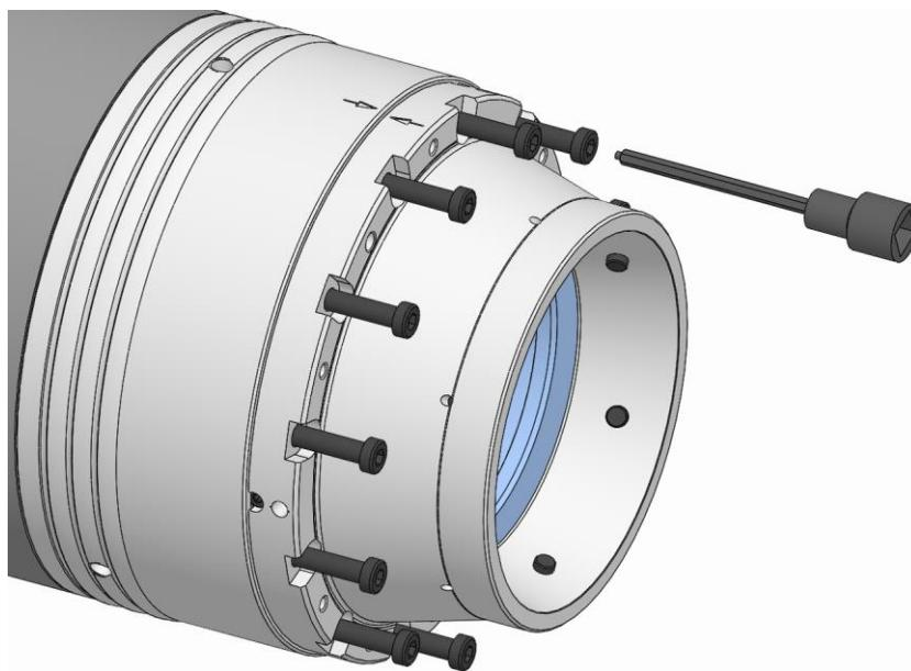
7. 機能ユニットの止めネジを刃先ガイド付きドライバービットでねじ込み、規定の締付けトルクで締めます（「ネジの締め付けトルク」の章を参照）。
