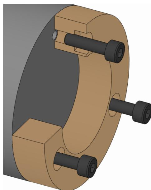
1. 換装部品の止めネジを緩め、取り外します。
