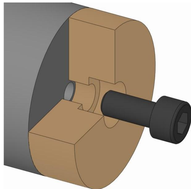
1. 換装部品の止めネジを緩め、取り外します。
