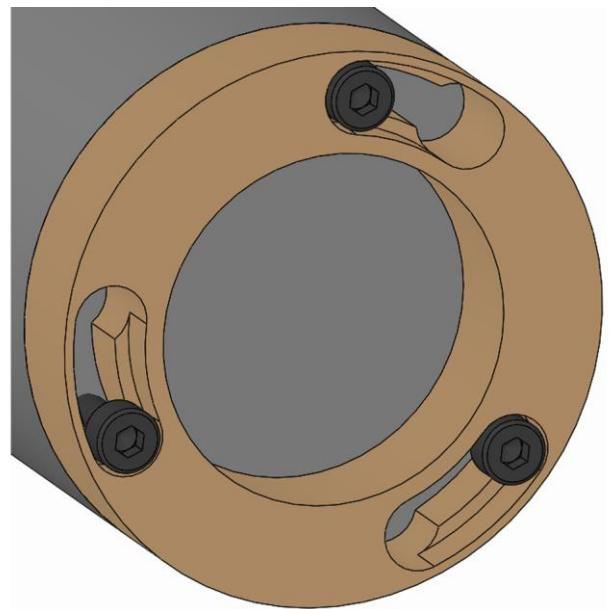
2. 換装部品の止めネジのネジ頭がバヨネット開口部に合うように、換装部品を回転します。
