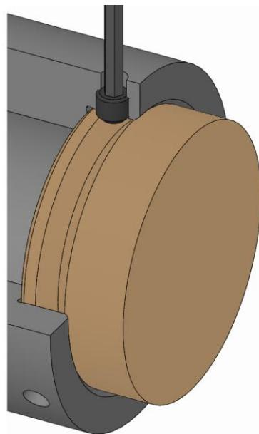
2. 換装部品の締め付けネジをねじ込み、規定の締付けトルクで締めます（「ネジの締め付けトルク」の章を参照）。
