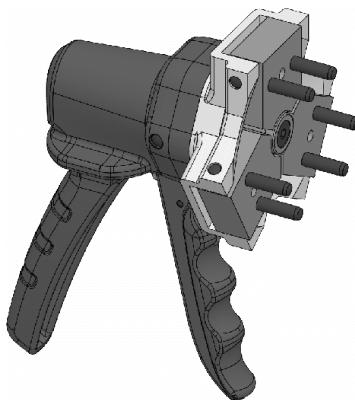
コレット交換工具のピンをクランピングヘッド端面の穴に差し込みます。コレット交換工具を手動で操作し、クランピングヘッドをコレットチャックに取り付けます。コレット交換工具は、サイズに応じて片手または両手で操作できるように作られています。クランピングヘッドはコレット交換工具にチャックされ、交換工具によりコレットチャックに取り付けられます。
