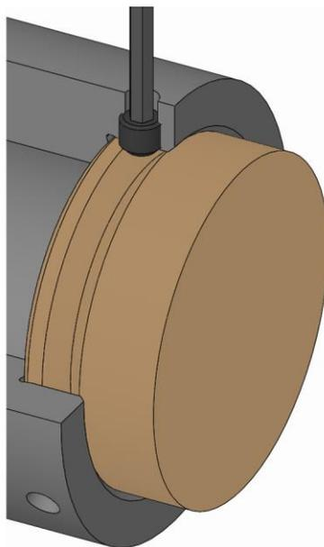
2. 換装部品の締め付けネジをねじ込み、規定の締め付けトルクで締めます（「ネジの締め付けトルク」の章を参照）。
