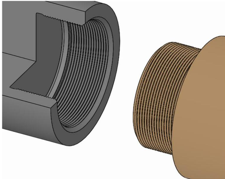
1. 換装部品はそのネジ溝を回して製品から取り外します。
