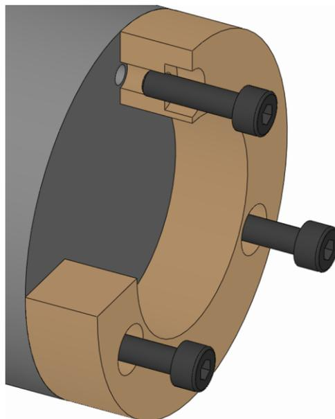
2. 換装部品の止めネジをねじ込み、規定の締め付けトルクで締めます（「ネジの締め付けトルク」の章を参照）。
