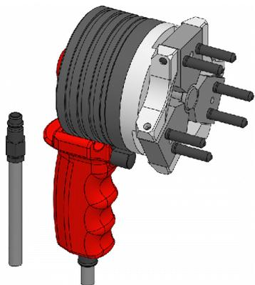
コレット交換工具のピンをクランピングヘッド端面の穴に差し込みます。コレット交換工具をエア圧により駆動し、クランピングヘッドをコレットチャックに取り付けます。コレット交換工具は、サイズに応じて片手または両手で操作できるように作られています。クランピングヘッドはコレット交換工具にチャックされ、交換工具によりコレットチャックに取り付けられます。
