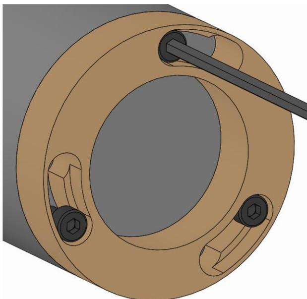
3. 換装部品の止めネジを規定の締め付けトルクで締めます（「ネジの締め付けトルク」の章を参照）。
