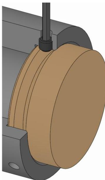
1. 換装部品を取り外せるようになるまで、換装部品の締め付けネジを緩めます。
