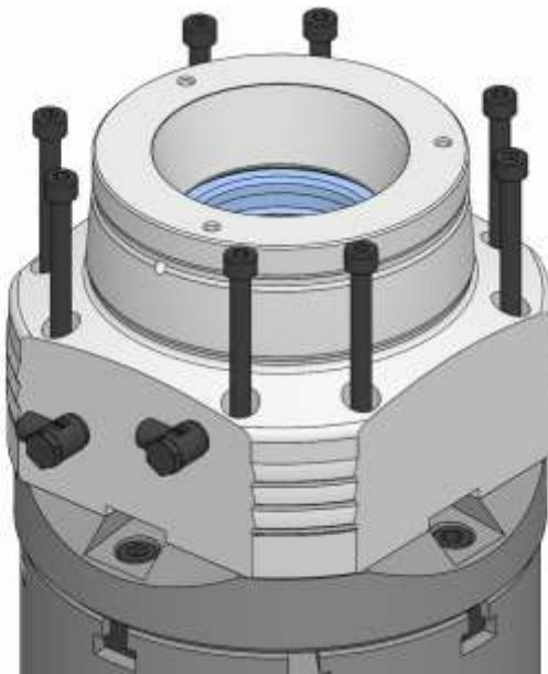
5. 製品の止めネジを緩め、取り外します。
