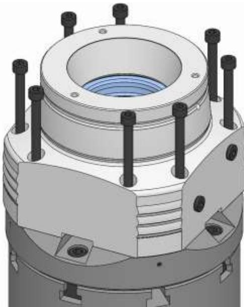
4. 製品の止めネジを緩め、取り外します。
