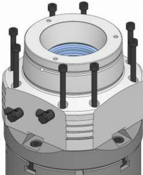
6. 本製品の止めネジをねじ込み、軽く固定します。
