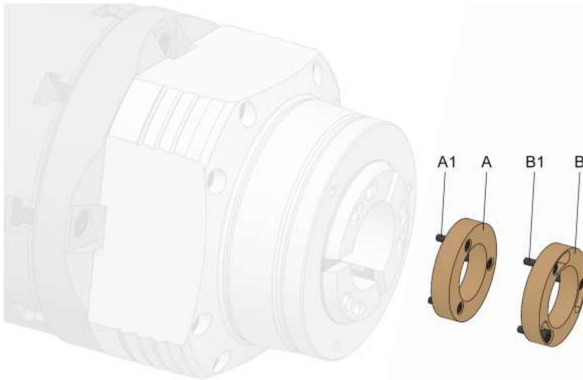
A 換装部品を側面から ×箇所、クサビ式で固定する
