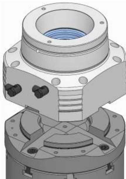
5. 本製品を機械テーブル/ベースプレートに設置します。
