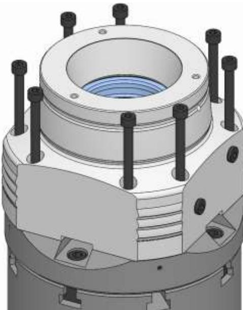
6. 本製品の止めネジをねじ込み、軽く固定します。
