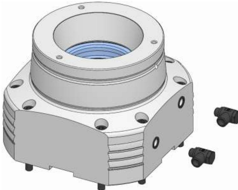
4. めがね継手をねじ込み、規定の締付けトルクで締めます（「ネジの締め付けトルク」の章を参照）。
