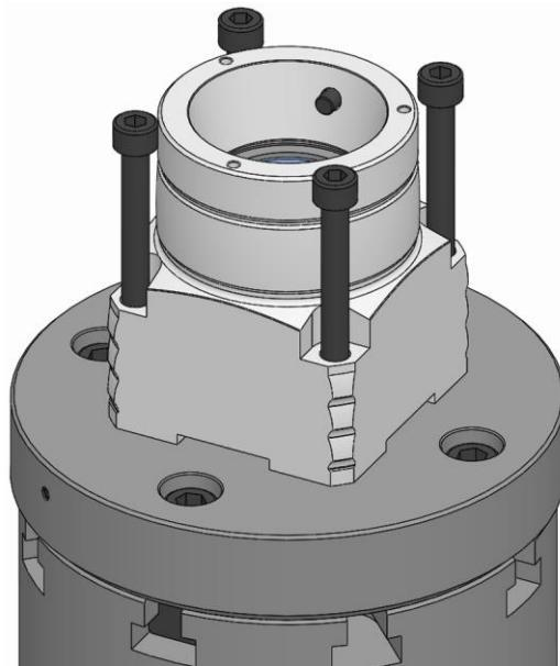
4. 製品の止めネジを緩め、取り外します。
