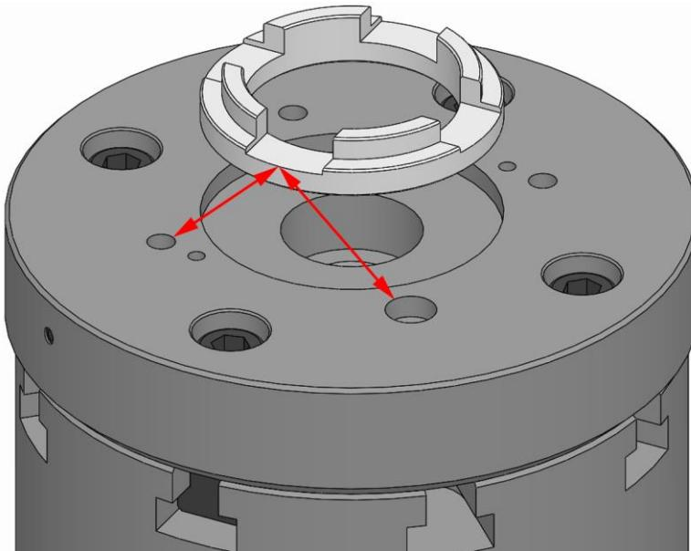
5. センタリングリングを機械テーブル/ベースプレートに挿入します。センタリングリングの溝が常に本製品の固定ネジのネジ山の間にあるように、センタリングリングの芯出し調整をします。
