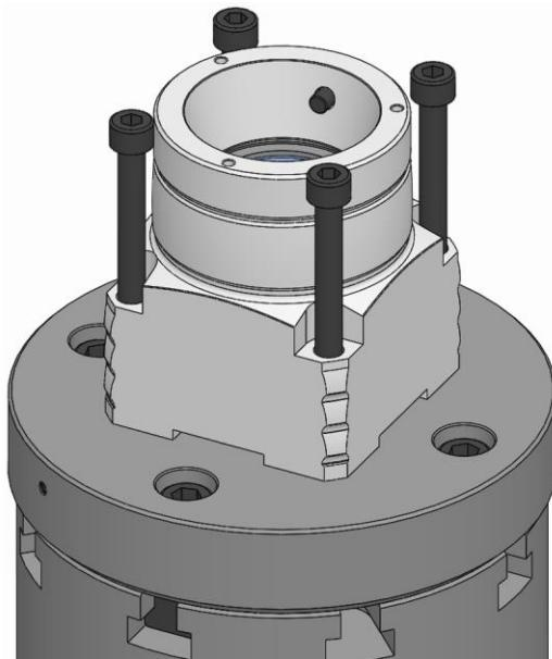
7. 本製品の止めネジをねじ込み、軽く固定します。
