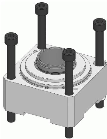
タンデムシリンダーをサイズ 32RD のハイドロックに適合させることで、50 バールで最大 70 kN のクランプ力を実現することができます。
