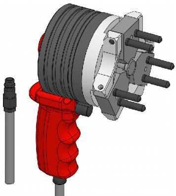
コレット交換工具のピンをクランピングヘッド端面の穴に差し込みます。コレット交換工具をエア一圧により駆動し、クランピングヘッドをコレットチャックに取り付けます。コレット交換工具は、サイズに応じて片手または両手で操作できるように作られています。クランピングヘッドはコレット交換工具にチャックされ、交換工具によりコレットチャックに取り付けられます。
