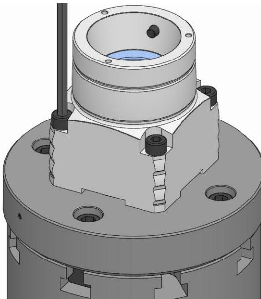
11. 本製品の止めネジを規定の締付けトルクで締めます（「ネジの締め付けトルク」の章を参照）。
