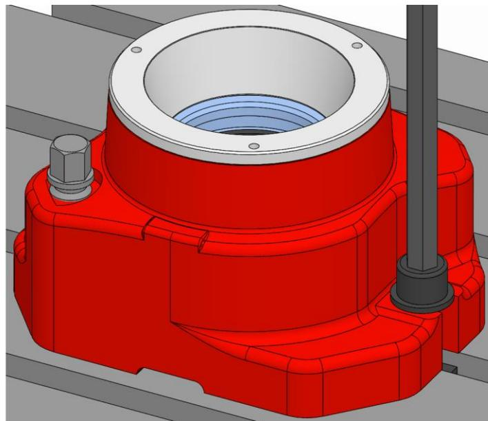
9. 本製品の止めネジを規定の締付けトルクで締めます（「ネジの締め付けトルク」の章を参照）。
