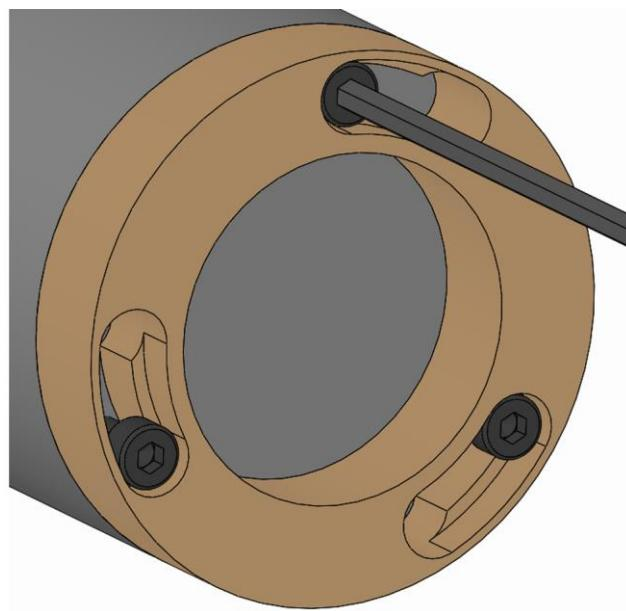
3. 換装部品の止めネジを規定の締付けトルクで締めます（「ネジの締め付けトルク」の章を参照）。
