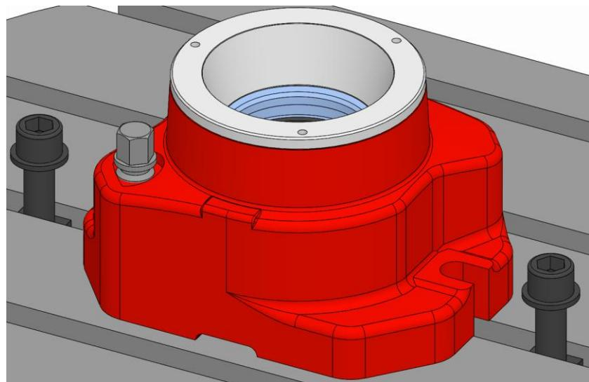
5. 製品の止めネジを緩め、取り外します。
