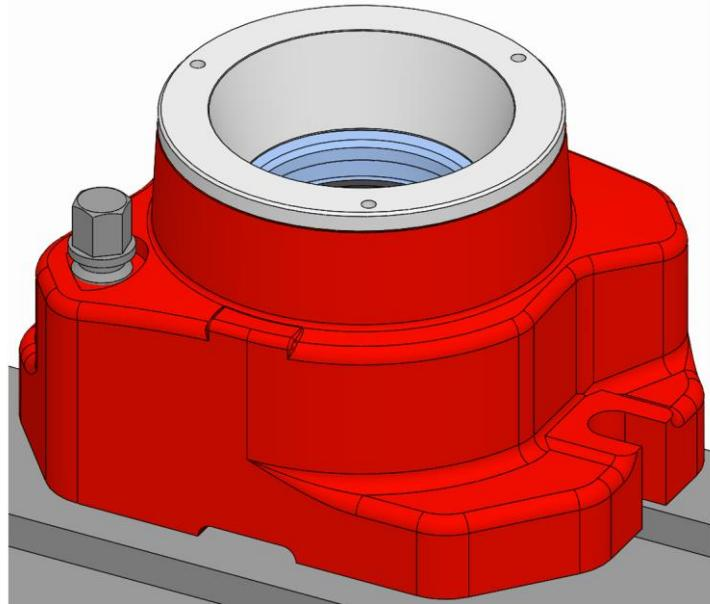
4. 本製品を機械テーブルに設置します。
