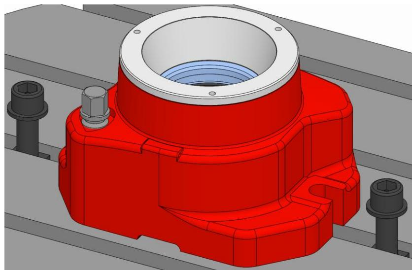
5. 本製品の止めネジをねじ込み、軽く固定します。
