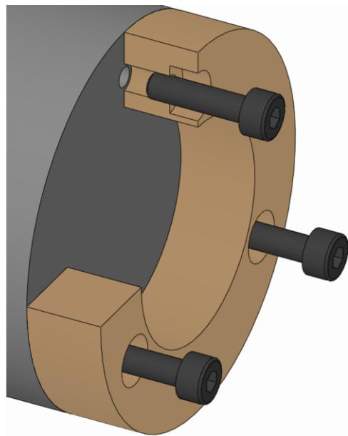
2. 換装部品の止めネジをねじ込み、規定の締付けトルクで締めます（「ネジの締め付けトルク」の章を参照）。
