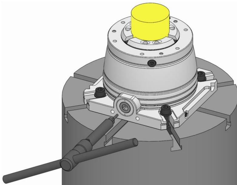
6. 作業用レンチをドライブから外して、機械の作業領域から取り出します。
