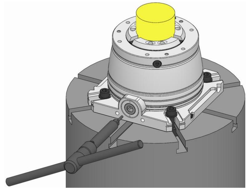
4. 作業用レンチをドライブから外して、機械の作業領域から取り出します。
