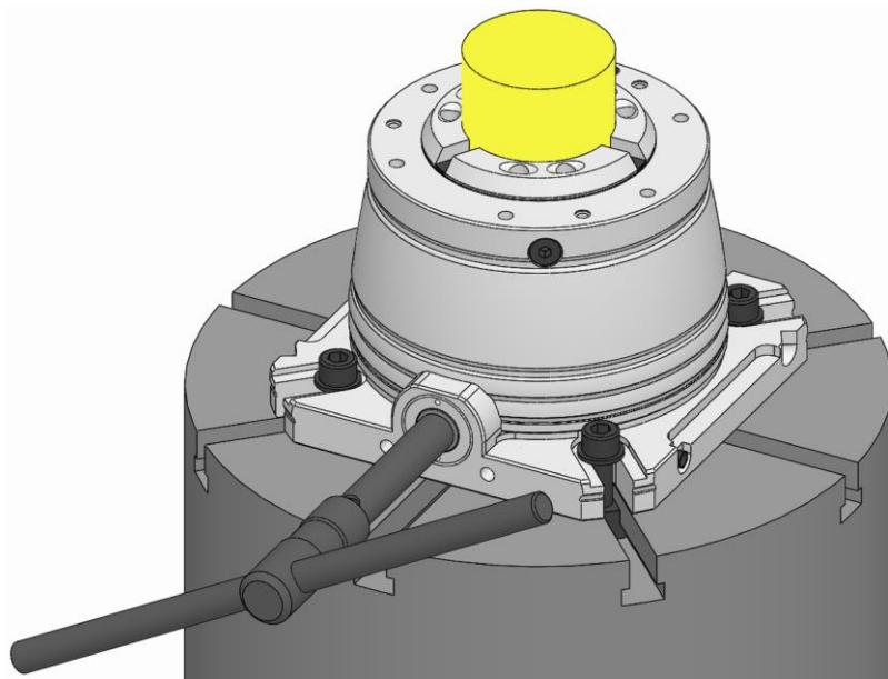
3. 作業用レンチを使用して、ドライブを左回りに止まるまで回転させます。
