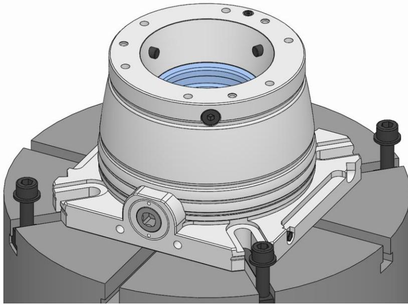
5. 本製品の止めネジをねじ込み、軽く固定します。
