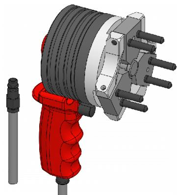
コレット交換工具のピンをクランピングヘッド端面の穴に差し込みます。コレット交換工具をエアーアイにより駆動し、クランピングヘッドをコレットチャックに取り付けます。コレット交換工具は、サイズに応じて片手または両手で操作できるように作られています。クランピングヘッドはコレット交換工具にチャックされ、交換工具によりコレットチャックに取り付けられます。
