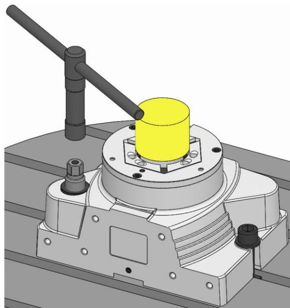
4. 作業用レンチを作業ネジから外して、機械の作業領域から取り出します。
