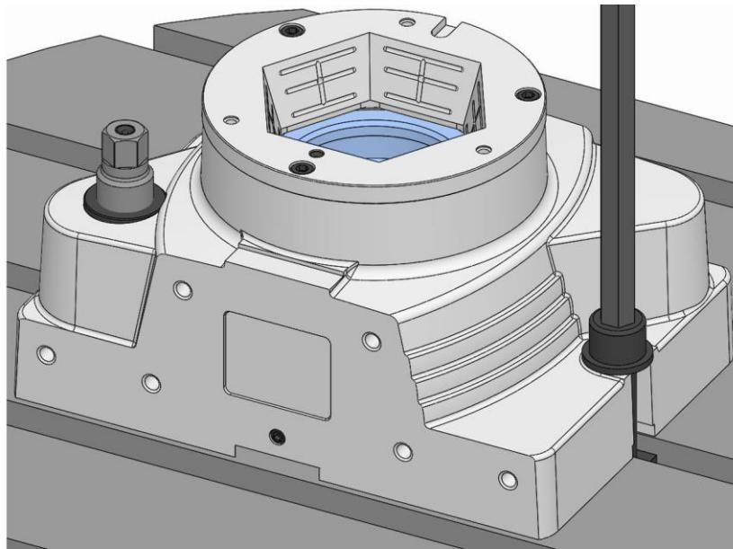
9. 本製品の止めネジを規定の締付けトルクで締めます（「ネジの締め付けトルク」の章を参照）。
