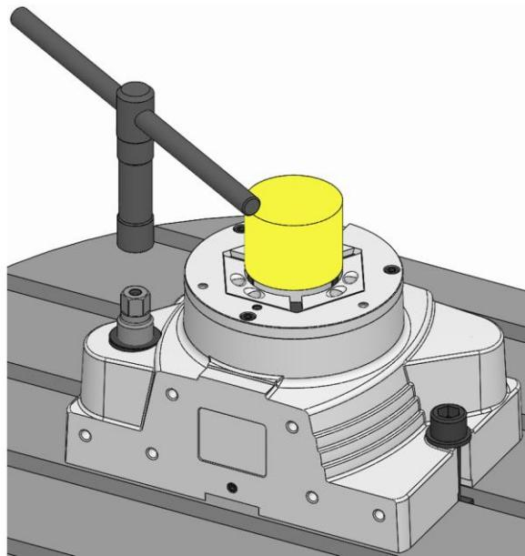
5. 作業用レンチを作業ネジから外して、機械の作業領域から取り出します。
