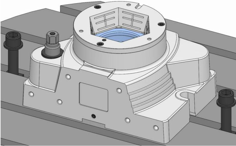
5. 本製品の止めネジをねじ込み、軽く固定します。
