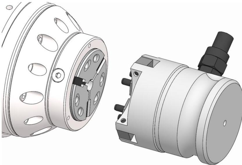
4. コレット交換工具のピンをクランピングヘッドの交換穴に挿入します。
