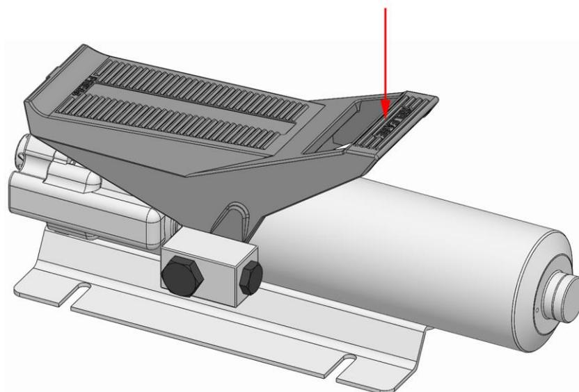
9. 増圧フットペダルの前方ロッカー側を踏んでコレット交換工具を解放すると、クランピングヘッドが解放されて、油圧が低下します。
