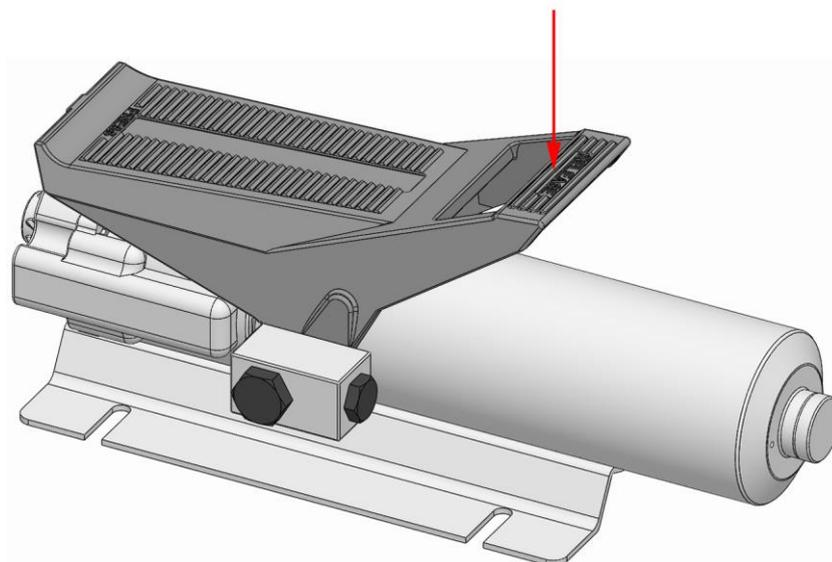
9. 増圧フットペダルの前方ロッカー側を踏んでコレット交換工具を解放すると、クランピングヘッドがかみ合い、油圧が低下します。
