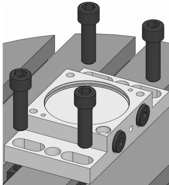
5. 製品の止めネジをねじ込み、規定の締付けトルクで締めます（「ネジの締め付けトルク」の章を参照）。
