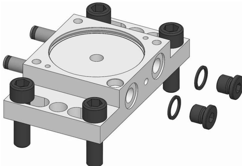
1. ベースプレートからネジ込プラグを外し、ネジ込プラグシールを取り外します。
