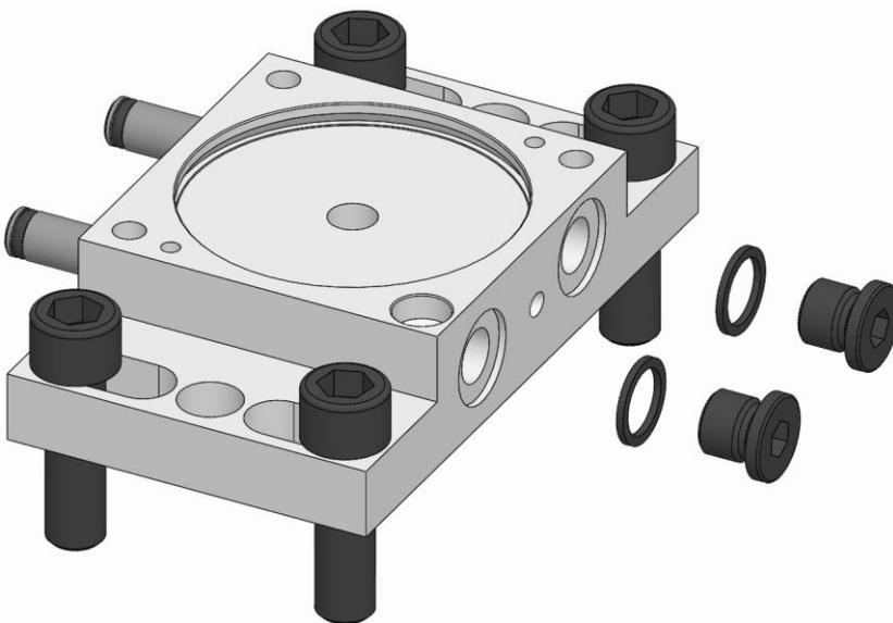
1. ベースプレートからネジ込プラグを外し、ネジ込プラグシールを取り外します。
